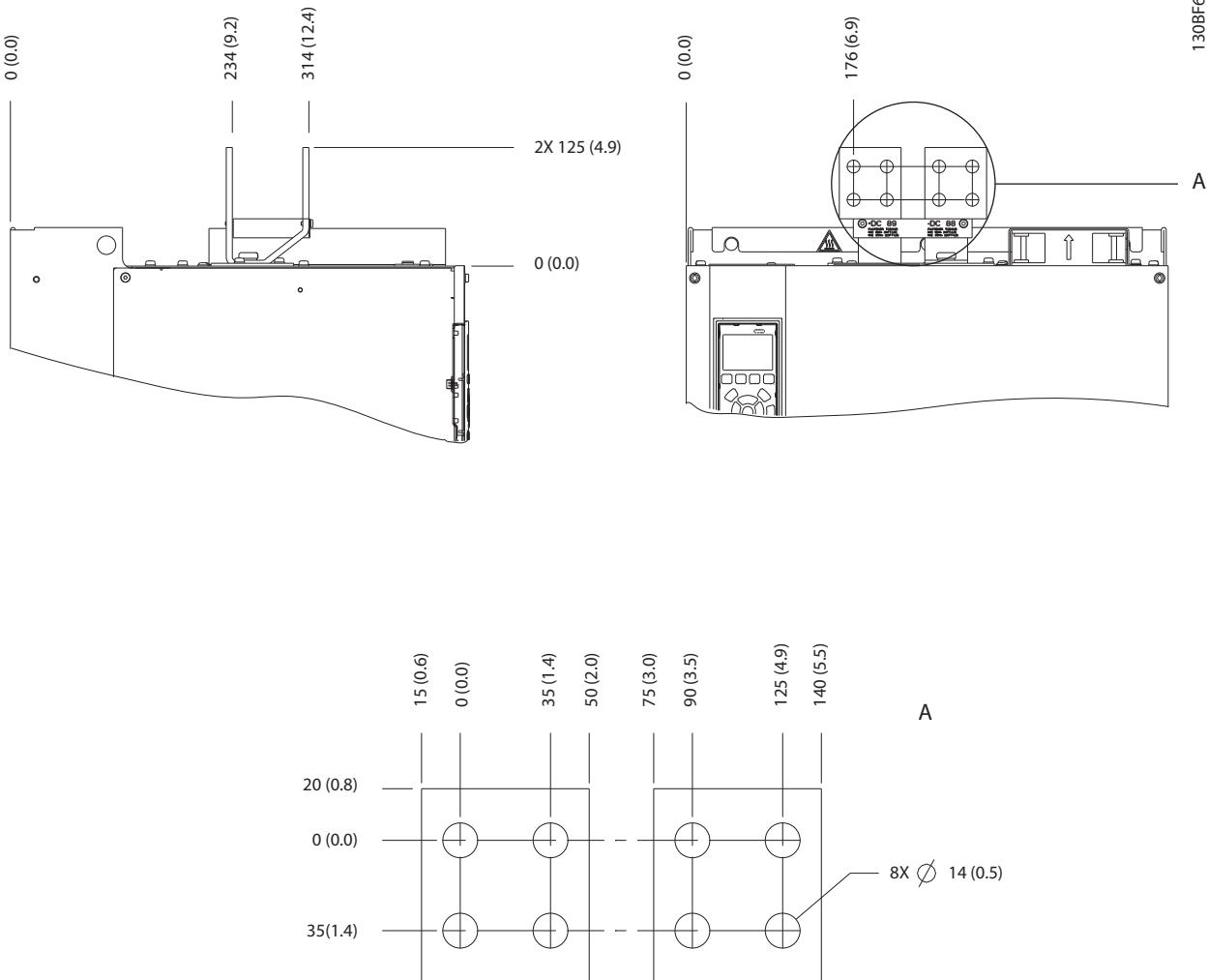
Slika 5.12 Dimenziije stezaljke s udjelom opterećenja/regeneracijske stezaljke za E3h
