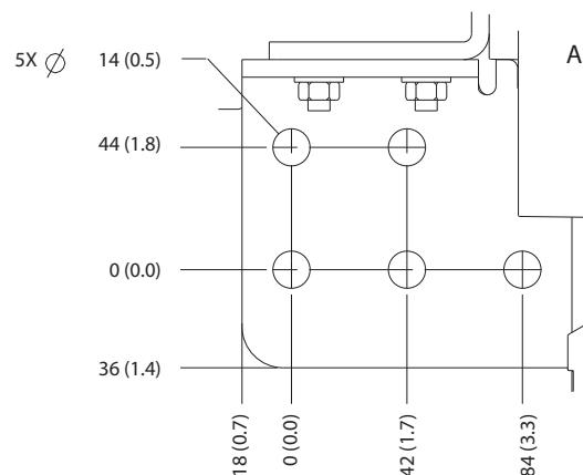
Slika 5.9 Dimenzije stezaljke E2h (bočni prikazi)
