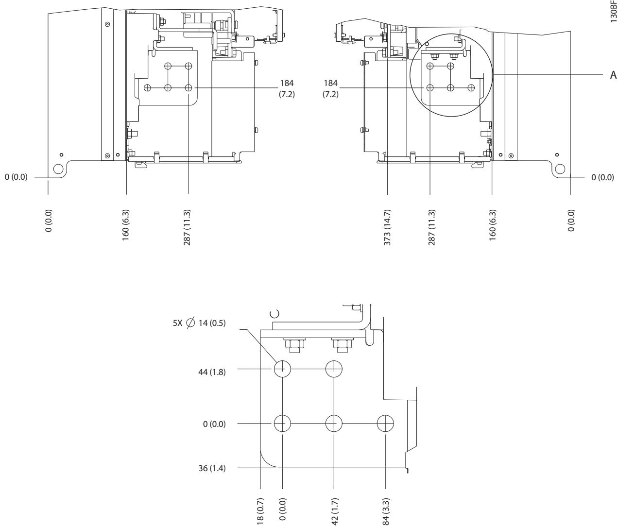
Slika 5.14 Dimenzijske stezaljki za mrežno napajanje, motor i uzemljenje za E4h (bočni prikazi)
