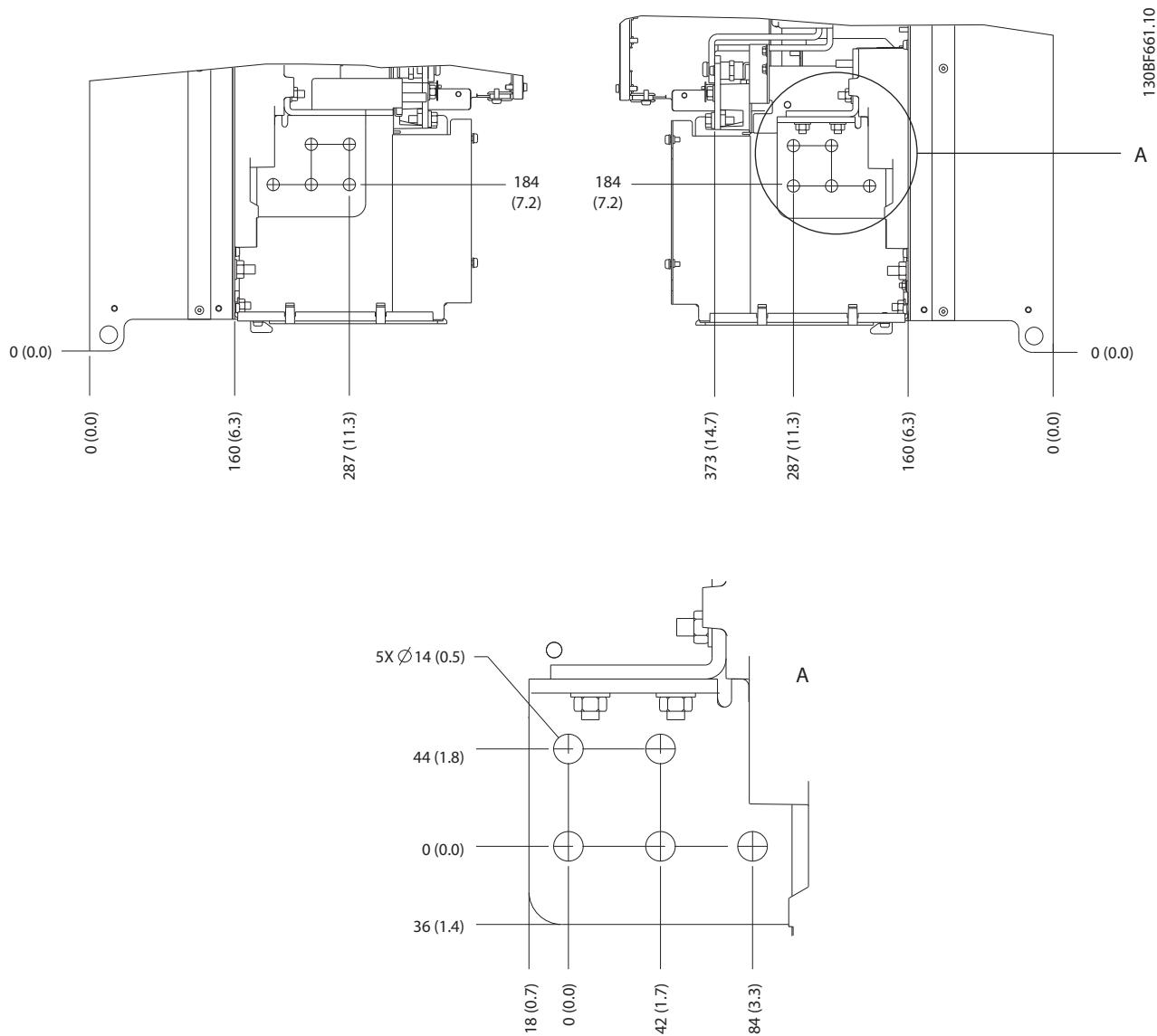
Slika 5.11 Dimenzijske stezaljki za mrežno napajanje, motor i uzemljenje za E3h (bočni prikazi)
