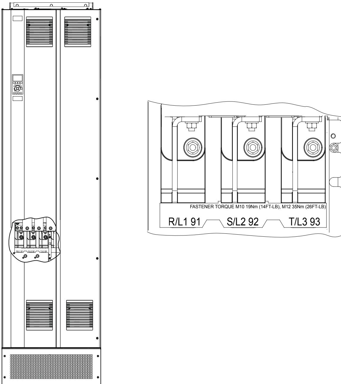
Slika 5.4 Stezaljke za izmjenično mrežno napajanje (pričuvano kućište E1h). Za detaljan prikaz stezaljki pogledajte poglavlje 5.7 Dimenzije stezaljki
