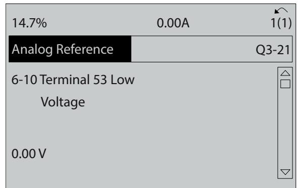
Slika 6.8 Parametar 6-10 Stezaljka 53 Niski napon
