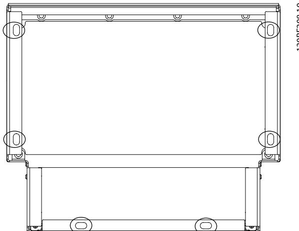
Slika 4.3 Točke za montažu podesta na pod
