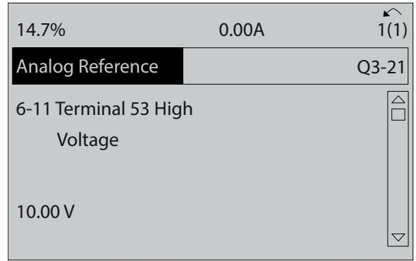
Slika 6.9 Parametar 6-11 Stezaljka 53 Visoki napon
