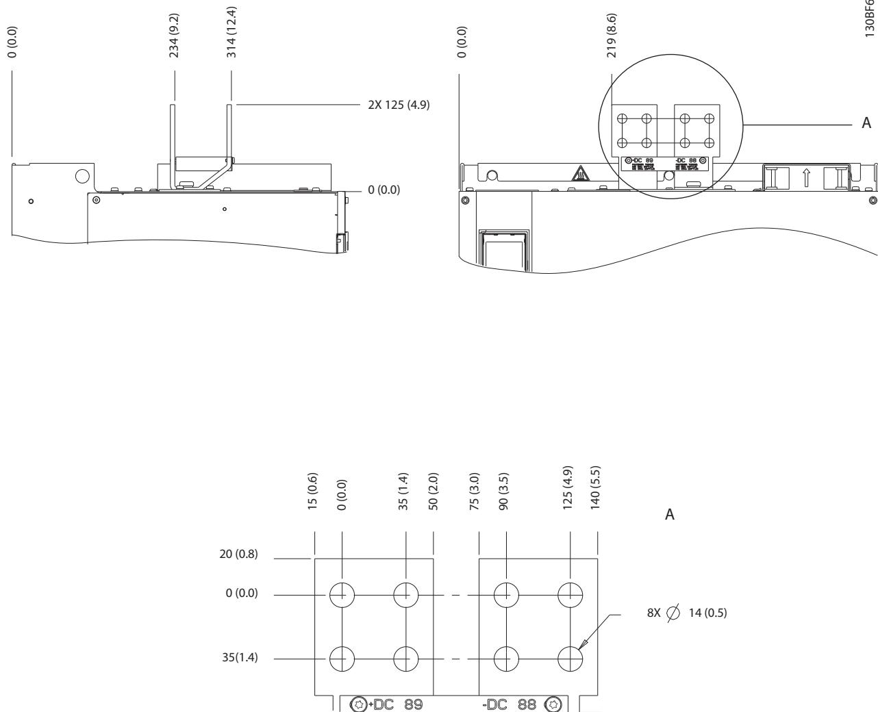
Slika 5.15 Dimenzijske stezaljke s udjelom opterećenja/regeneracijske stezaljke za E4h
