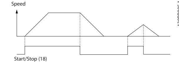
Slika 7.2 Naredba Start/Stop (Pokretanje/Zaustavljanje) sa funkcijom Safe Torque Off
