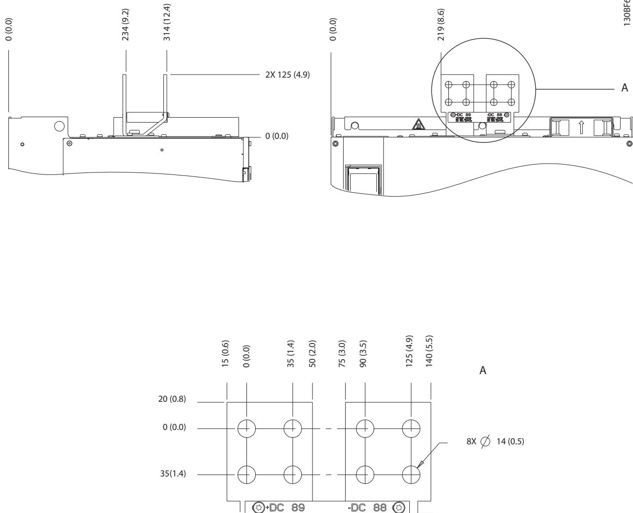
Ilustrasi 5.15 Dimensi Terminal Pembagi Beban/Regenerasi E4h
