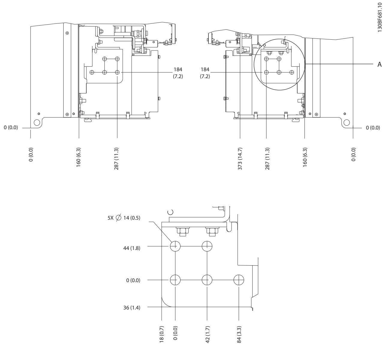
Ilustrasi 5.14 Dimensi Terminal Sumber Listrik, Motor, dan Pemburni E4h (Tampak Samping)
