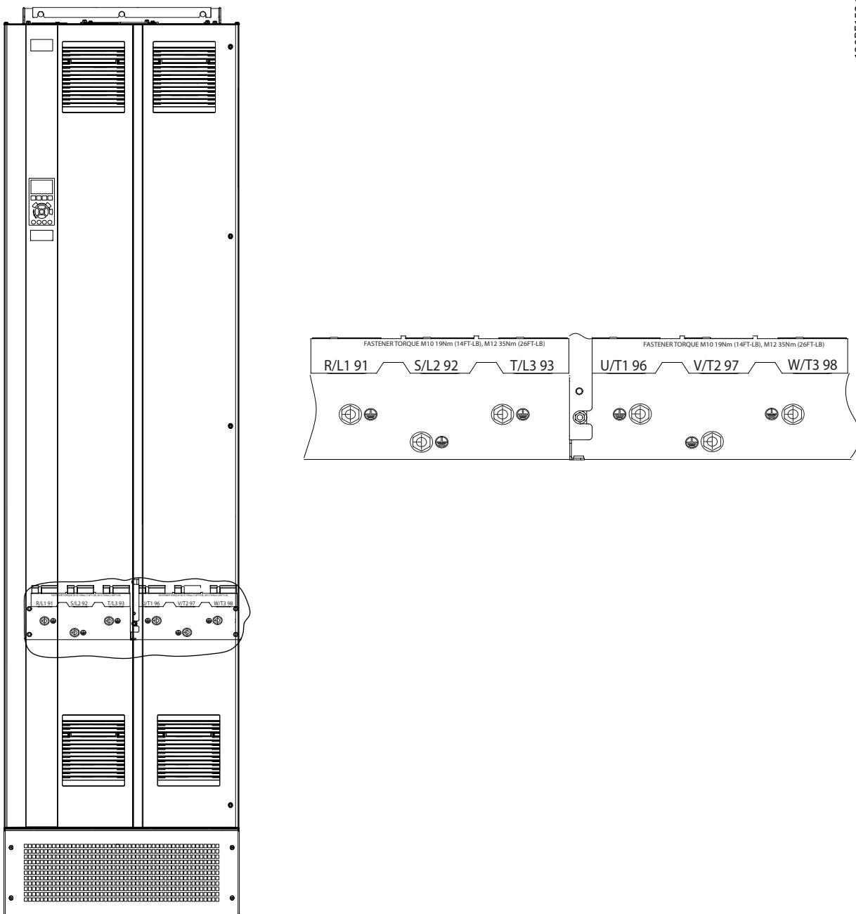
Ilustrasi 5.5 Terminal pembumi (E1h terlihat). Untuk tampilan rinci terminal, lihat *bab 5.7 Dimensi Terminal*
