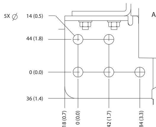
Ilustrasi 5.9 Dimensi Terminal E2h (Tampak Samping)
