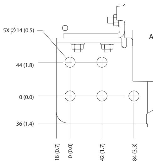
Ilustrasi 5.11 Dimensi Terminal Sumber Listrik, Motor, dan Pemburni E3h (Tampak Samping)
