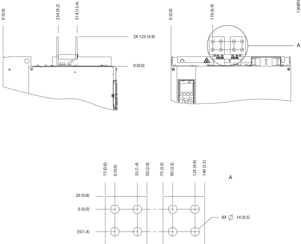
**Ilustrasi 5.12 Dimensi Terminal Pembagi Beban/Regenerasi E3h**
