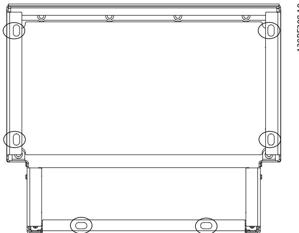
Ilustrasi 4.3 Pijakan ke Titik Pemasangan di Lantai
