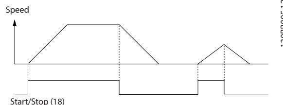
Ilustrasi 7.2 Perintah Mulai/Berhenti dengan Safe Torque Off
