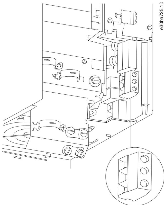
Ilustracija 13: Veličina kućišta H10, IP20, 600 V, 11–15 kW (15–20 KS)
