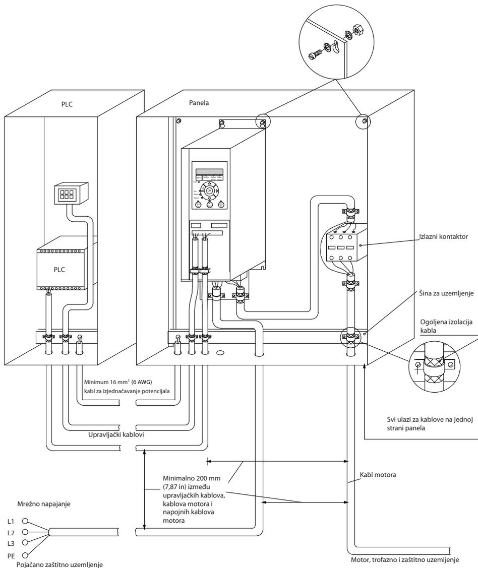
Ilustracija 22: Električna instalacija u skladu sa EMC
