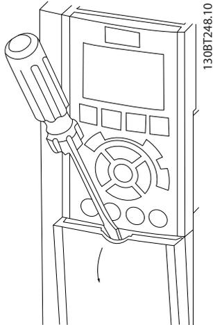
그림 4.3 IP20 및 IP21 외함의 배선 접근 방법
