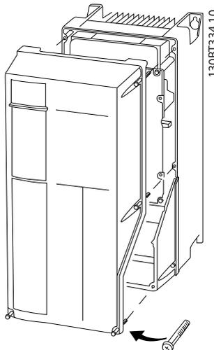
그림 4.4 IP55 및 IP66 외함의 배선 접근 방법
