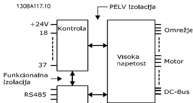
Ilustracija 8.1 PELV izolacija analognih vhodov
