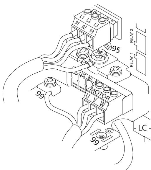
Ilustracija 4.6 Primer motorja, električnega omrežja in ozemljitve
