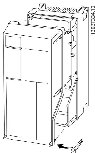
Slika 4.4 Pristup ožičenju za kućišta IP55 i IP66
