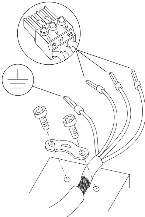
Slika 4.5 Priključak motora
