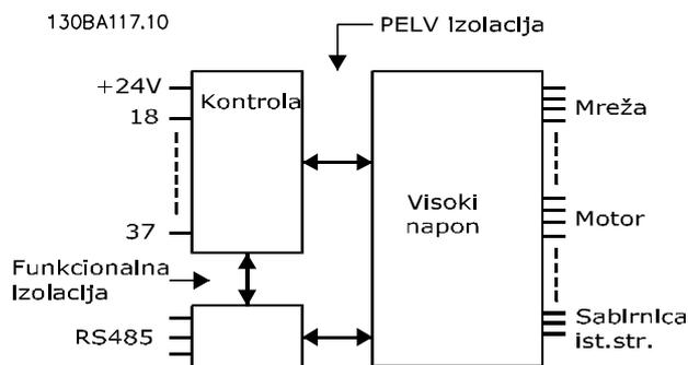
Slika 8.1 PELV izolacija analognih ulaza
