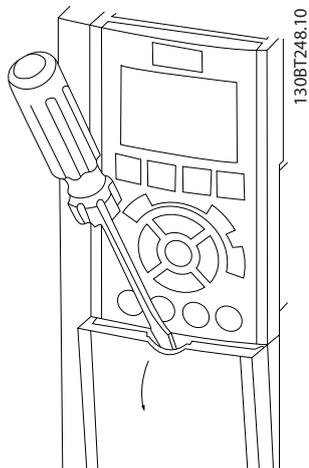
Slika 4.3 Pristup ožičenju za kućišta IP20 i IP21
