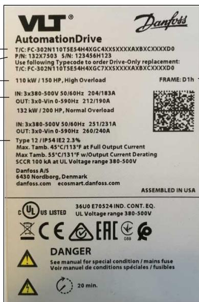
Obrázek 1: Příklad typového kódu na typovém štítku
