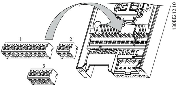
Ilustración 4.9 Ubicaciones de los terminales de control
