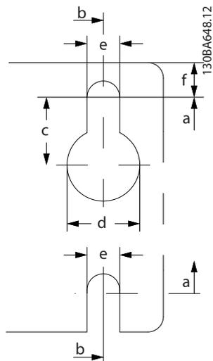
Ilustración 9.5 Agujeros de montaje superiores e inferiores
