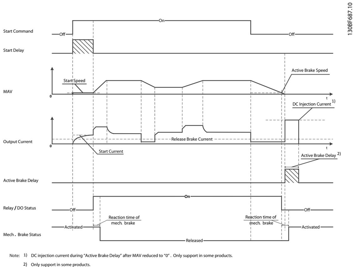
Ilustración 4.11 Freno mecánico
