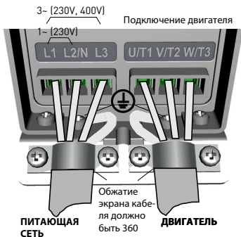
Рис. 3.17: Подключение силовых кабелей преобразователя Vacon 20, MI1
