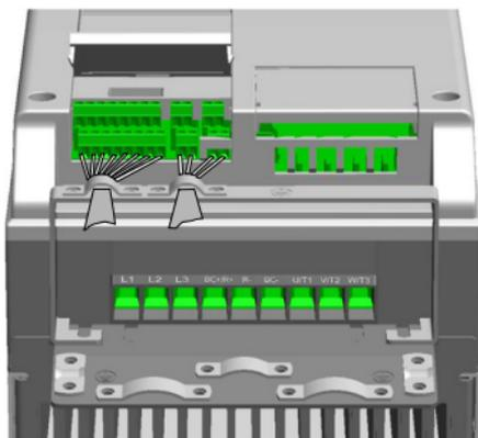
Figure 17 : Installation des câbles de commande, MI4-MI5
