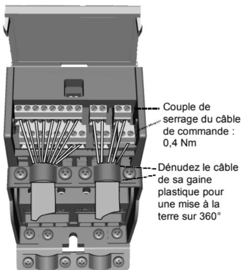
Figure 16 : Installation des câbles de commande, MI1-MI3
