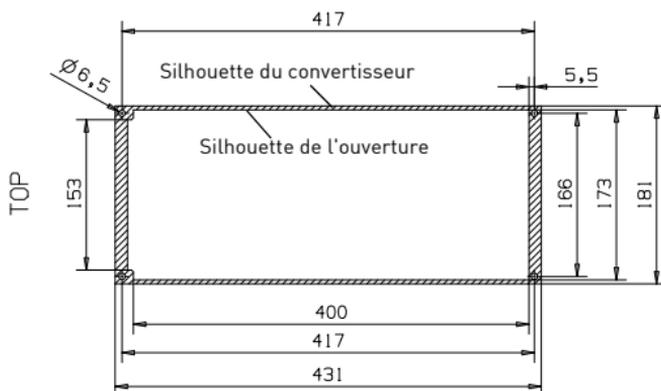
Figure 6 : Dimensions de découpe en montage par bride, pour MI5 (unité : mm)
