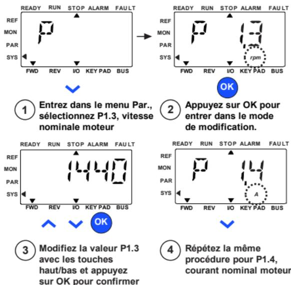
Figure 20 : Assistant de démarrage du Vacon 20 (application standard)
