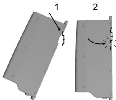
Figure 3 : Montage par rail DIN, MI1-MI3
