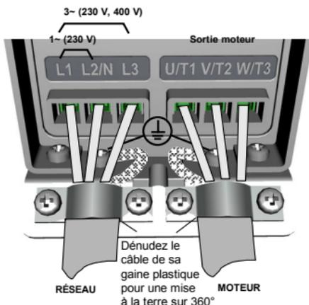
Figure 10 : Raccordements de puissance Vacon 20, MI1
