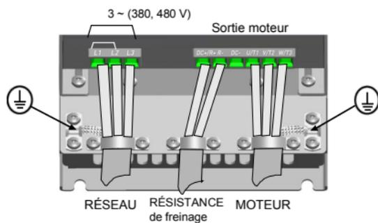
Figure 13 : Raccordements de puissance Vacon 20, MI5
