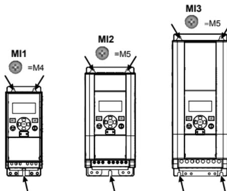
Figure 1 : Montage par vissage, MI1–MI3
