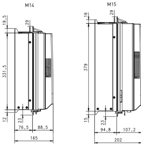
Figure 7 : Dimensions de profondeur en montage par bride, pour M14 et M15 (unité : mm)
