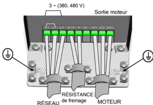
Figure 12 : Raccordements de puissance Vacon 20, MI4
