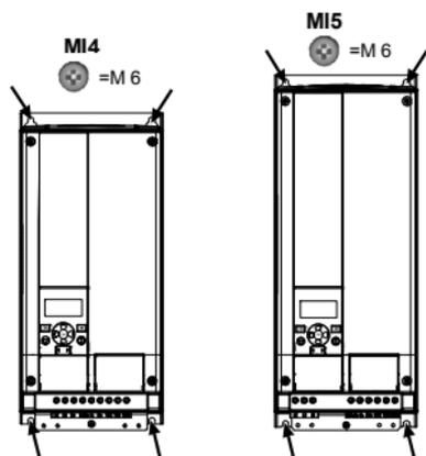
Figure 2 : Montage par vissage, MI4–MI5
