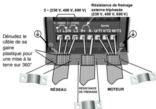
Figure 11 : Raccordements de puissance Vacon 20, MI2-MI3
