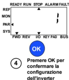
Figura 21: Configurazione dell'inverter
