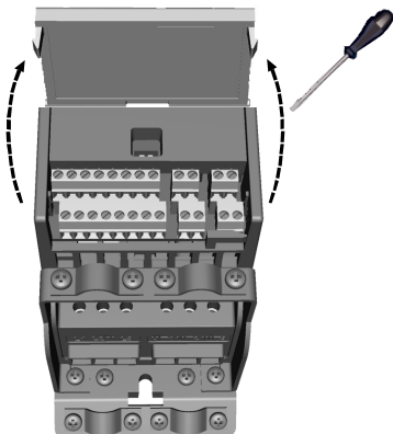
Figur 14: Åpne dekselet for MI1–MI3
