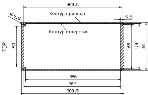
Рис. 5. Размеры выреза для фланцевого крепления приводов типоразмеров MI4 (ед. изм.: мм)
