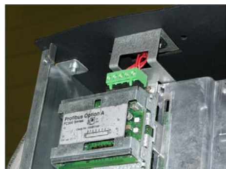
Illustration 4.9: Topforbindelse til fieldbus.
