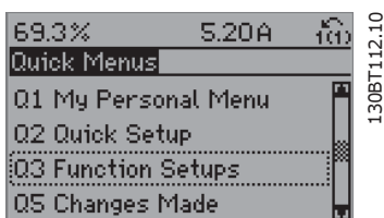
Abbildung 6.4: Schritt 3: Mit den Auf/Ab-Navigationstasten zu Funktionssätzen blättern. [OK] drücken.
