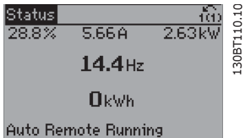
Abbildung 6.2: Schritt 1: Den Frequenzumrichter einschalten (gelbe LED leuchtet auf).
