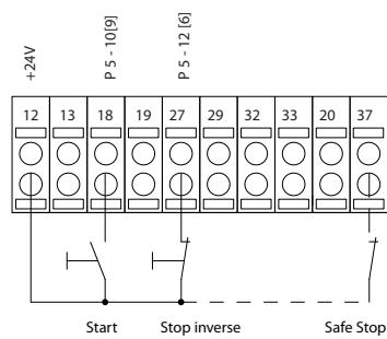
Illustration 4.21 Wiring Pulse Start/Stop
