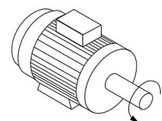
Il senso di rotazione può essere invertito scambiando due fasi nel cavo del motore oppure cambiando l'impostazione di 4-10 *Direz. velocità motore*.
