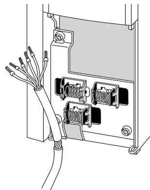
Collegare i cavi come descritto nel Manuale di funzionamento del convertitore di frequenza. Ricordarsi di collegare opportunamente le schermature in modo da assicurare il miglior livello di immunità elettrica.
