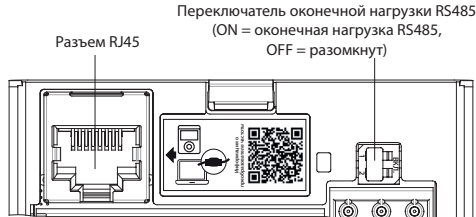
Рис. 4. Разъем RJ45 и переключатель оконечной нагрузки RS485
