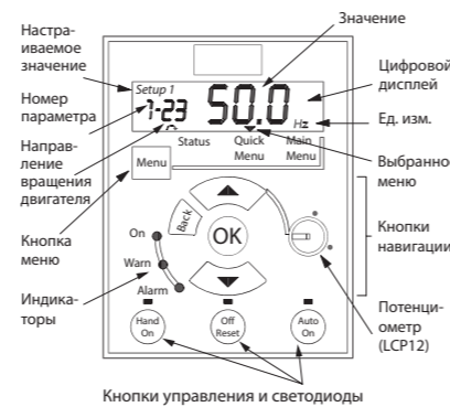
Рис. 5. Описание кнопок и дисплея панели управления
