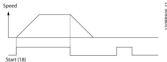
图 6.2 带安全停止功能的启动/停止命令
