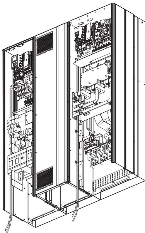
图 4.7 机箱规格 E9 的控制卡接线路径
