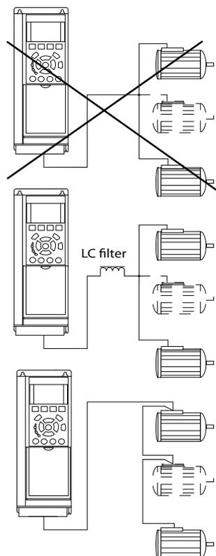
图 4.15 电缆连接到公共接点的系统
