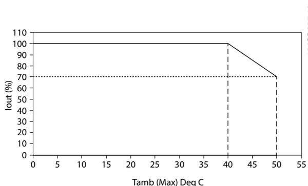
图 8.11 输入/输出与 最高环境温度
