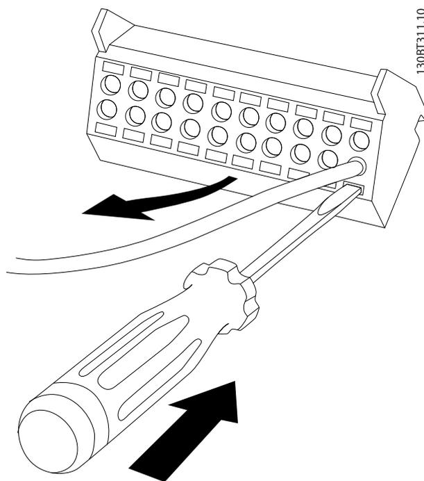
图 4.11 插入电缆后抽出螺丝刀
