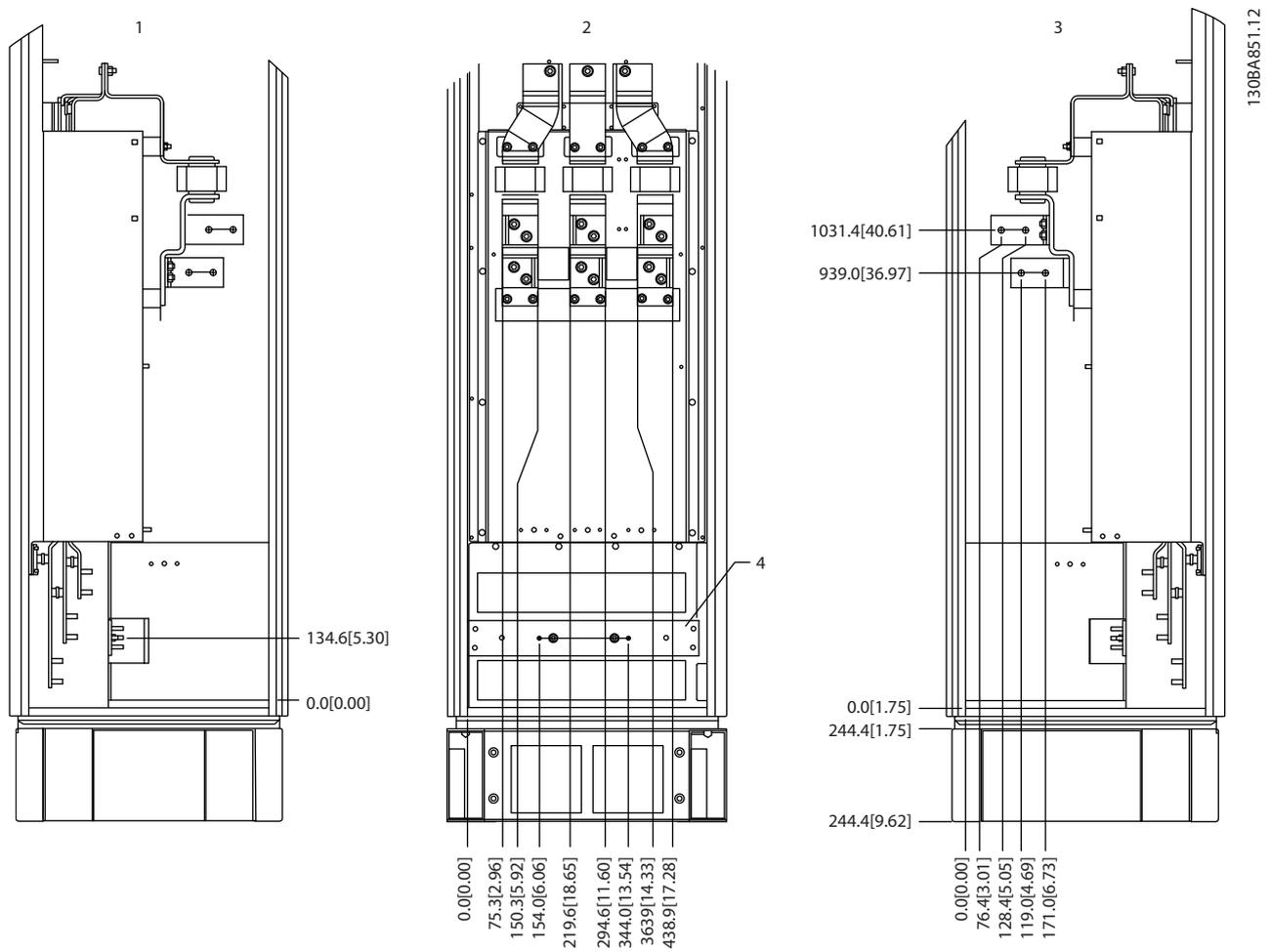
图 3.16 输入选件机柜，机架规格 F18 - 仅限熔断器
