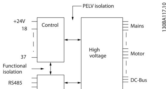
图 8.9 模拟输入的 PELV 绝缘
