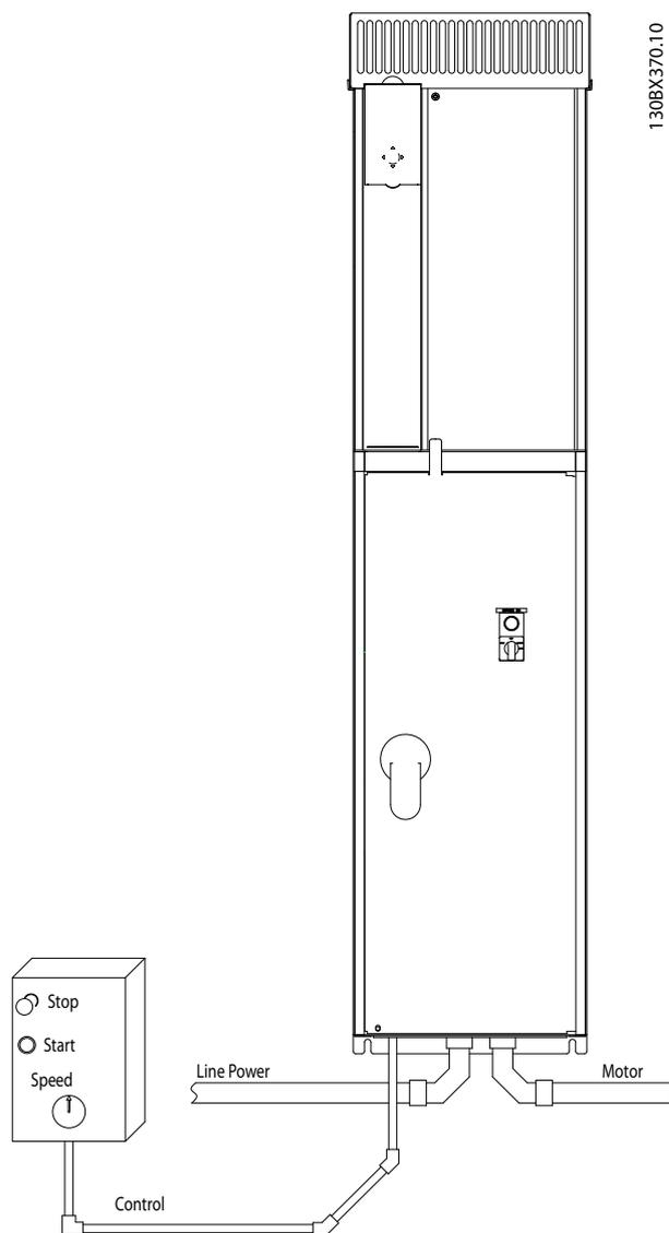
图 4.4 使用线管执行正确电气安装的示例
