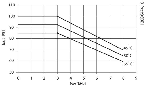
图 8.1 降容曲线 - 机箱规格 D、N160 至 N250 380-480 V (T5) 正常过载 110%、60 AVM
