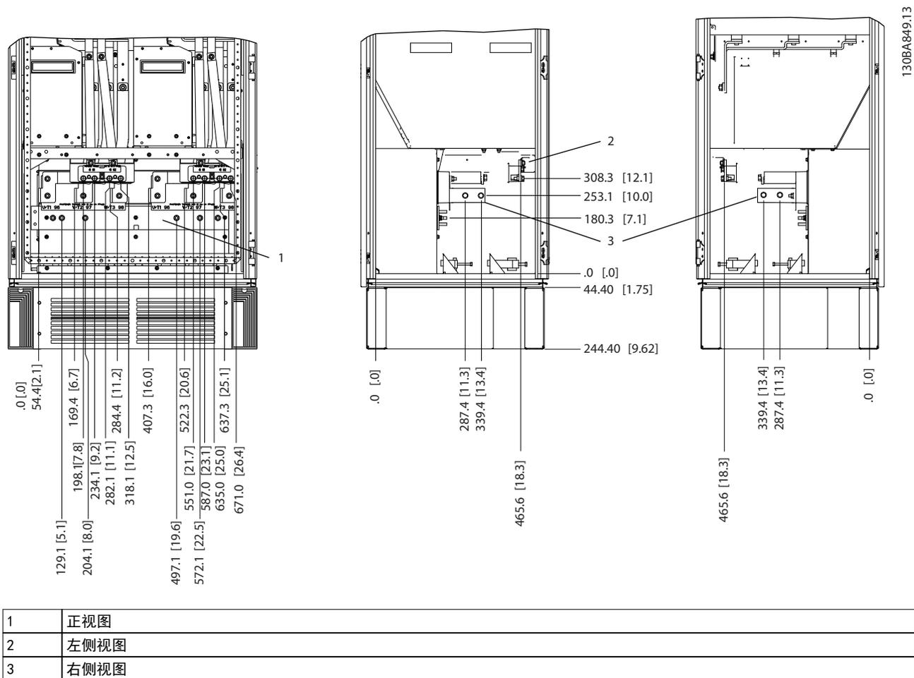
图 3.18 逆变器机柜, 机箱规格 F18
