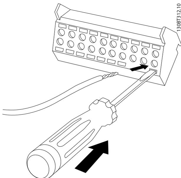
图 4.10 将电缆插入端子块中
