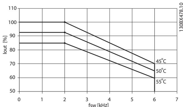
图 8.3 降容曲线 - 机箱规格 E 和 F、P315 至 P710 380-480 V (T5) 正常过载 110%、60 AVM
