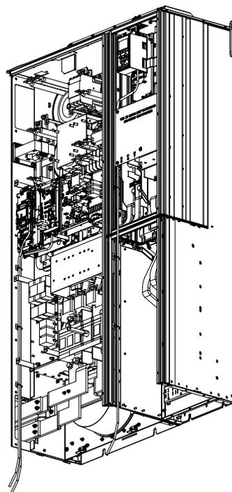
图 4.5 机箱规格 D1n 的控制卡接线路径
