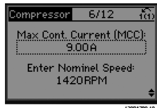
Abbildung 4.6 Strom- und Nenndrehzahleinrichtung
