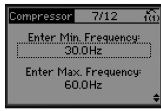
Abbildung 4.7 Einrichtung der min. und max. Frequenz
