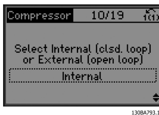
Abbildung 4.10 Auswahl von Betrieb mit oder ohne Rückführung
