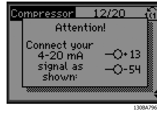
Abbildung 4.13 Info: 4-20-mA-Istwert gewählt - nehmen Sie die entsprechenden Anschlüsse vor
