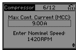
Disegno 4.6 Configurazione della velocità attuale e nominale
