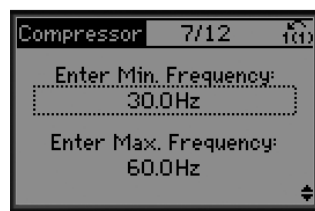
Disegno 4.7 Configurazione min. e max. della frequenza
