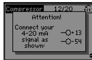
Disegno 4.13 Informazioni: retroazione 4-20 mA scelta - effettuare i collegamenti di conseguenza
