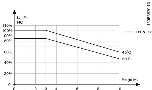
Illustration 6.14 Déclassement du courant de sortie avec fréquence de commutation et température ambiante pour variateurs de fréquence de 600 V, protection de type B, 60° AVM, SN
