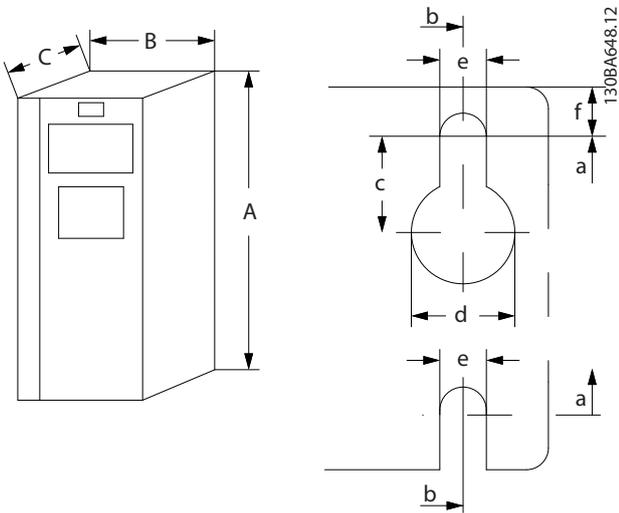
Illustration 7.16 Trous de fixation supérieurs et inférieurs
