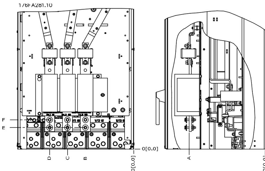
Ilustración 3.17: Posiciones de la conexión eléctrica del interruptor de desconexión en protección IP00
