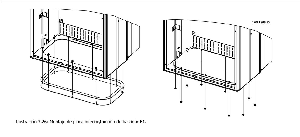
Ilustración 3.26: Montaje de placa inferior, tamaño de bastidor E1.
