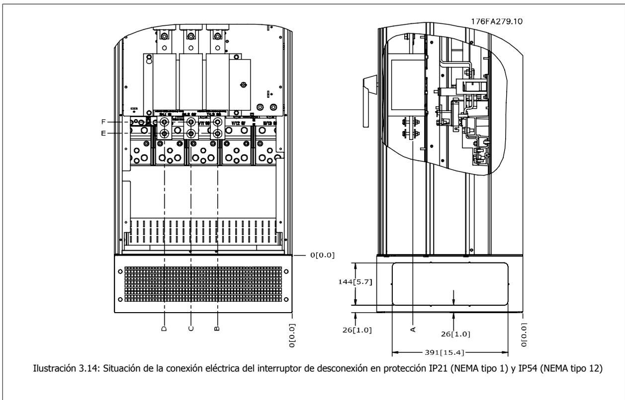
Ilustración 3.14: Situación de la conexión eléctrica del interruptor de desconexión en protección IP21 (NEMA tipo 1) y IP54 (NEMA tipo 12)
