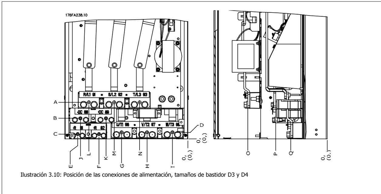
Ilustración 3.10: Posición de las conexiones de alimentación, tamaños de bastidor D3 y D4
