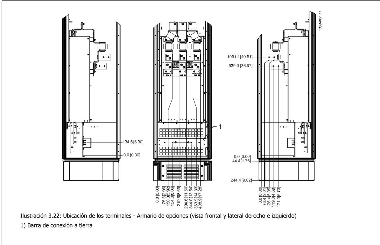
**Ubicación de los terminales - Armario de opciones con magnetotérmico/ conmutador de caja moldeada (F3 y F4)**
