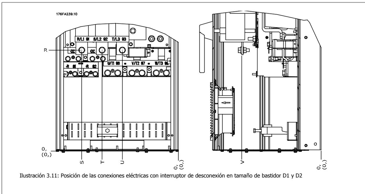
Ilustración 3.11: Posición de las conexiones eléctricas con interruptor de desconexión en tamaño de bastidor D1 y D2
