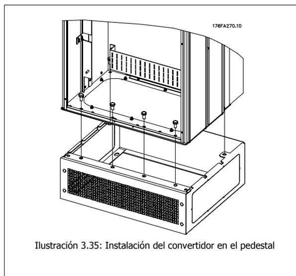
Ilustración 3.35: Instalación del convertidor en el pedestal
