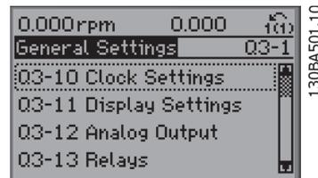
Ilustración 5.6: Paso 5: Use las teclas de navegación arriba/abajo para desplazarse hasta, por ejemplo, Q3-12 *Salidas analógicas*. Pulse [OK] (Aceptar)
