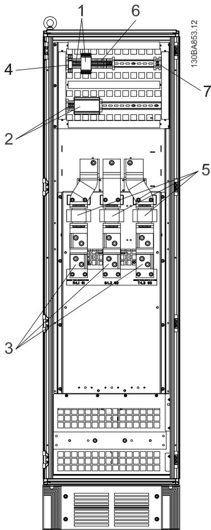
Ilustración 3.48: Armario de opciones, tamaño de bastidor F3 y F4
