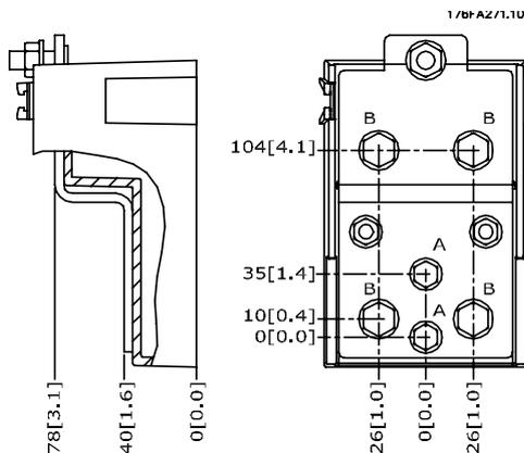
Ilustración 3.18: Detalle del terminal
