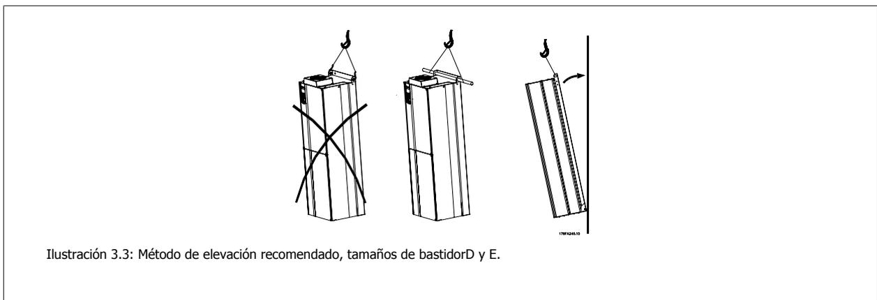
Ilustración 3.3: Método de elevación recomendado, tamaños de bastidor D y E.
