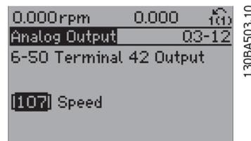
Ilustración 5.8: Paso 7: Use las teclas de navegación arriba/abajo para seleccionar entre las distintas opciones. Pulse [OK] (Aceptar)
