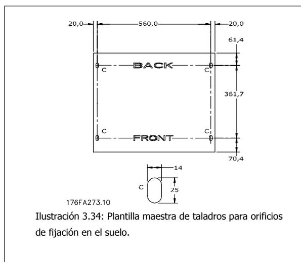
Ilustración 3.34: Plantilla maestra de taladros para orificios de fijación en el suelo.
