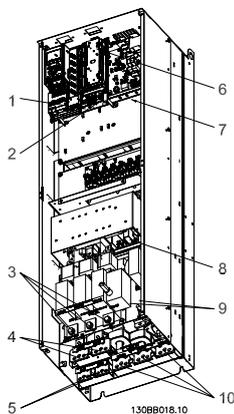
Ilustración 3.39: Compact IP 00 (chasis) con sistema de desconexión, fusible y filtro RFI, tamaño de bastidor D4
