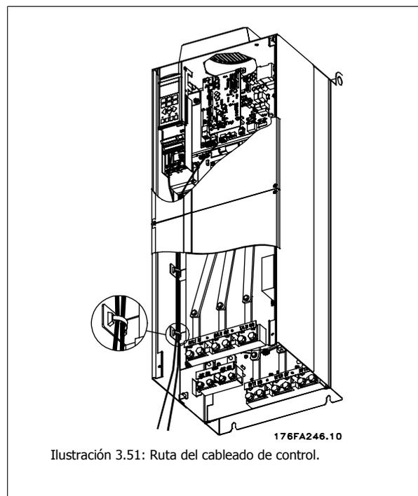
Ilustración 3.51: Ruta del cableado de control.
