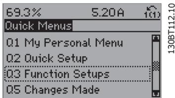
Ilustración 5.4: Paso 3: Use las teclas de navegación arriba/abajo para desplazarse por los Ajustes de función. Pulse [OK] (Aceptar)
