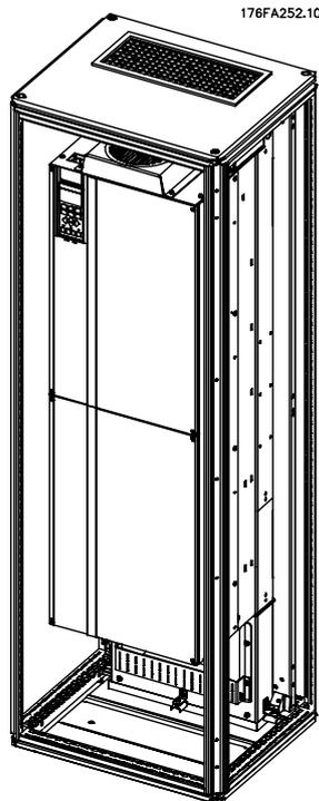
Ilustración 3.28: Instalación de en protección.
