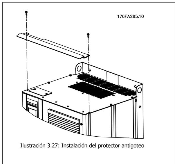
Ilustración 3.27: Instalación del protector antigoteo
