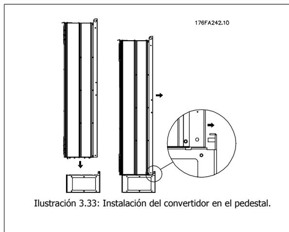
Ilustración 3.33: Instalación del convertidor en el pedestal.
