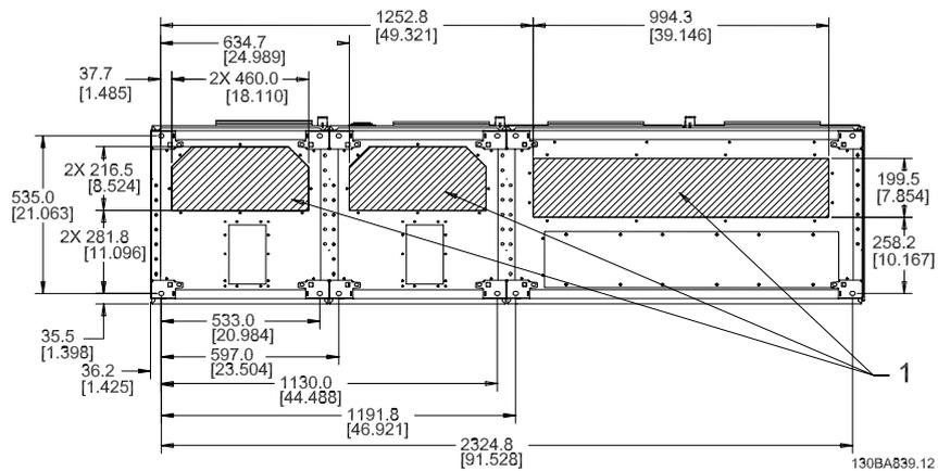
F1-F4: entradas de cable vistas desde la parte inferior del convertidor de frecuencia - 1) Colocar los conductos en las áreas marcadas
