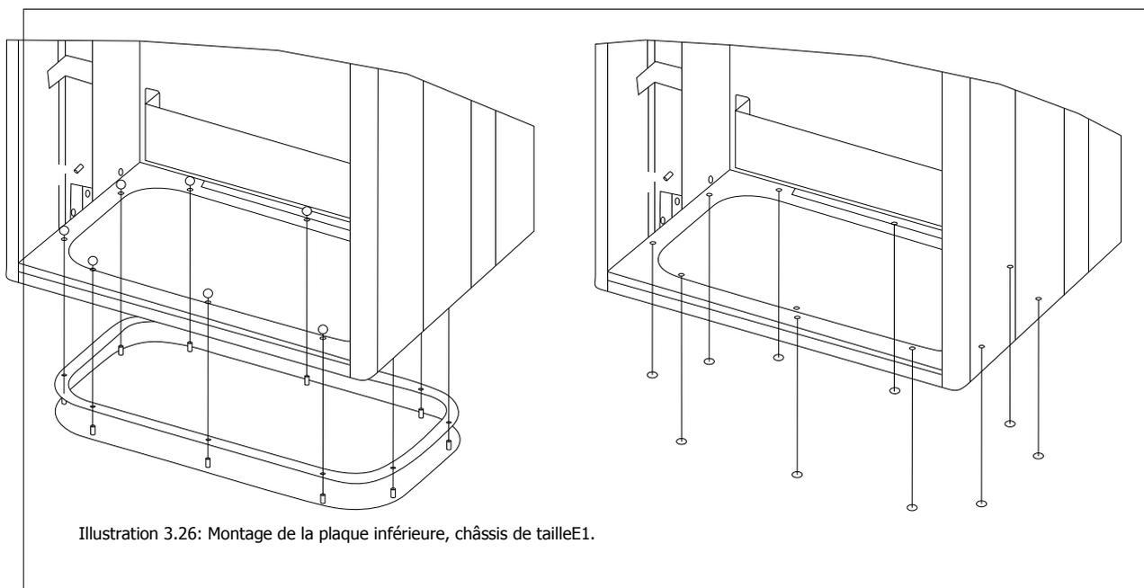
Illustration 3.26: Montage de la plaque inférieure, châssis de taille E1.
