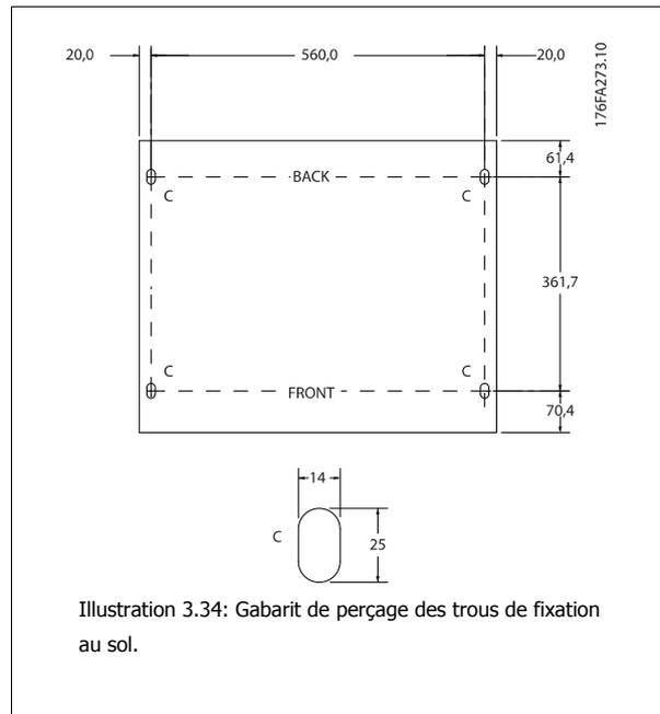
Monter le variateur sur le socle et le fixer au socle à l'aide des boulons inclus comme indiqué sur l'illustration.
