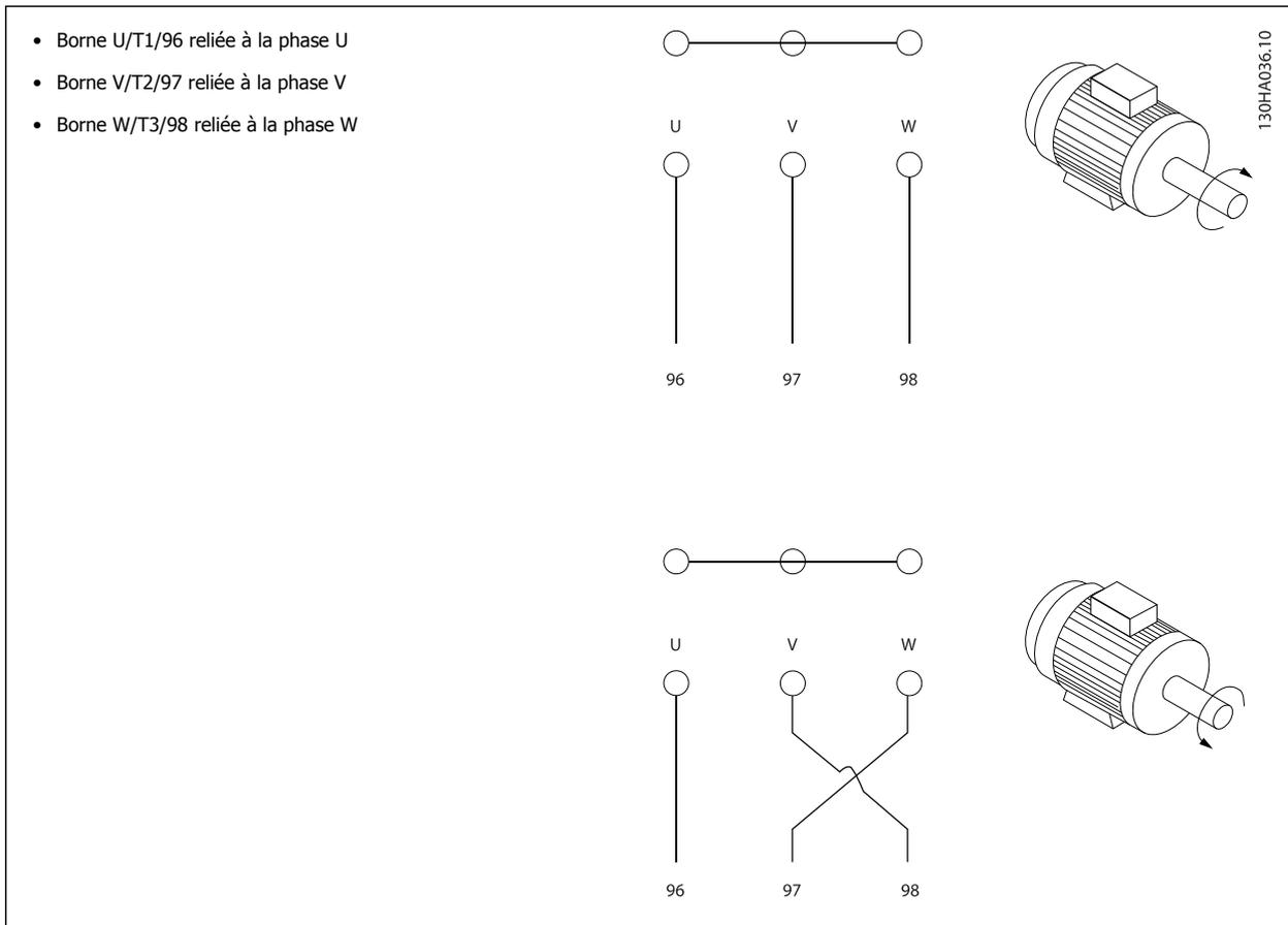
Le sens de rotation peut être modifié en inversant deux phases côté moteur ou en changeant le réglage du Par. 4-10 *Direction vit. moteur*.
