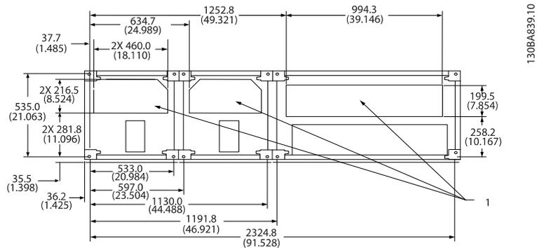
F1-F4 : entrées de câble vues depuis le bas du variateur de fréquence - 1) Placer les conduits dans les zones repérées
