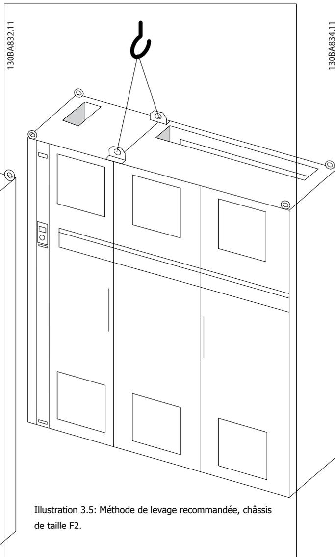
Illustration 3.5: Méthode de levage recommandée, châssis de taille F2.
