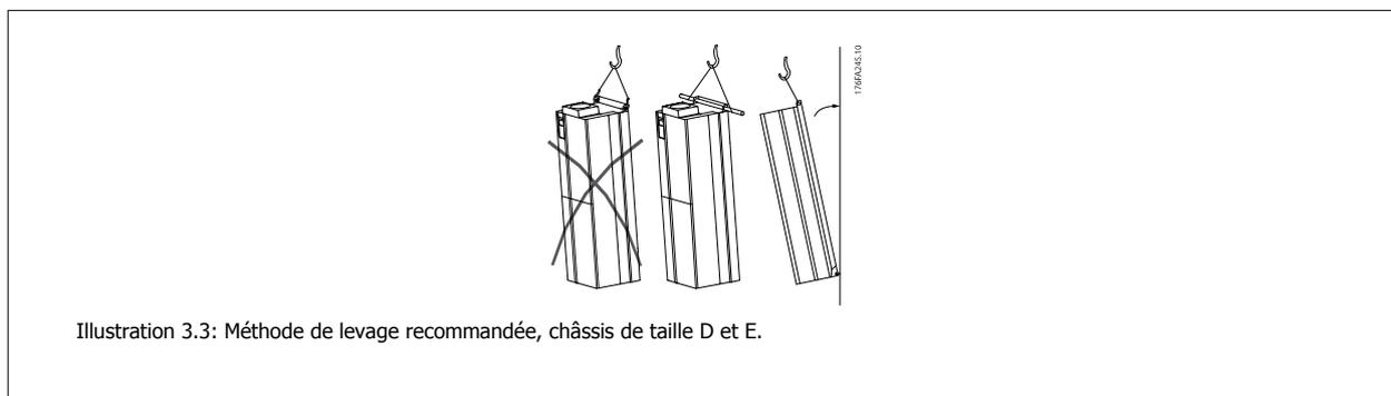
Illustration 3.3: Méthode de levage recommandée, châssis de taille D et E.
