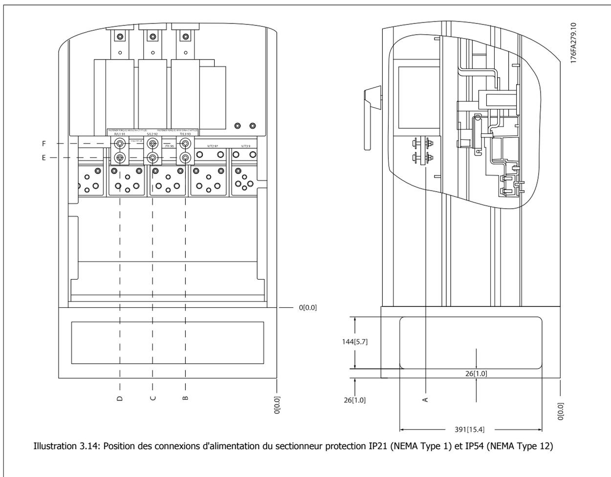
Illustration 3.14: Position des connexions d'alimentation du sectionneur protection IP21 (NEMA Type 1) et IP54 (NEMA Type 12)
