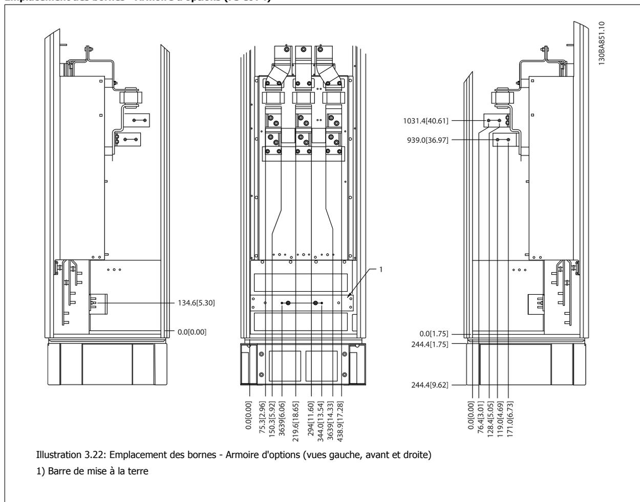
Illustration 3.22: Emplacement des bornes - Armoire d'options (vues gauche, avant et droite)
