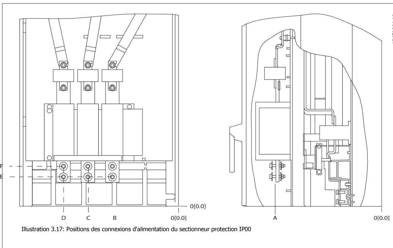
Noter que les câbles de puissance sont lourds et difficiles à plier. Considérer la position optimale du variateur de fréquence pour garantir une installation facile des câbles.
