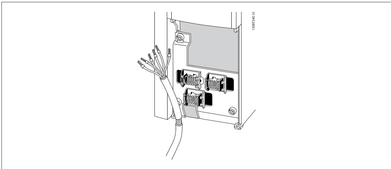
Raccorder les fils comme décrit dans le Manuel d'utilisation du variateur de fréquence. Ne pas oublier de connecter les blindages correctement pour assurer une immunité électrique optimale.
