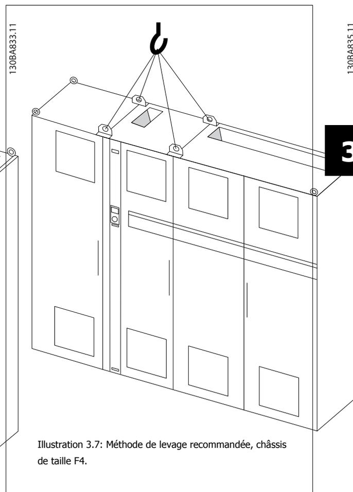
Illustration 3.7: Méthode de levage recommandée, châssis de taille F4.
