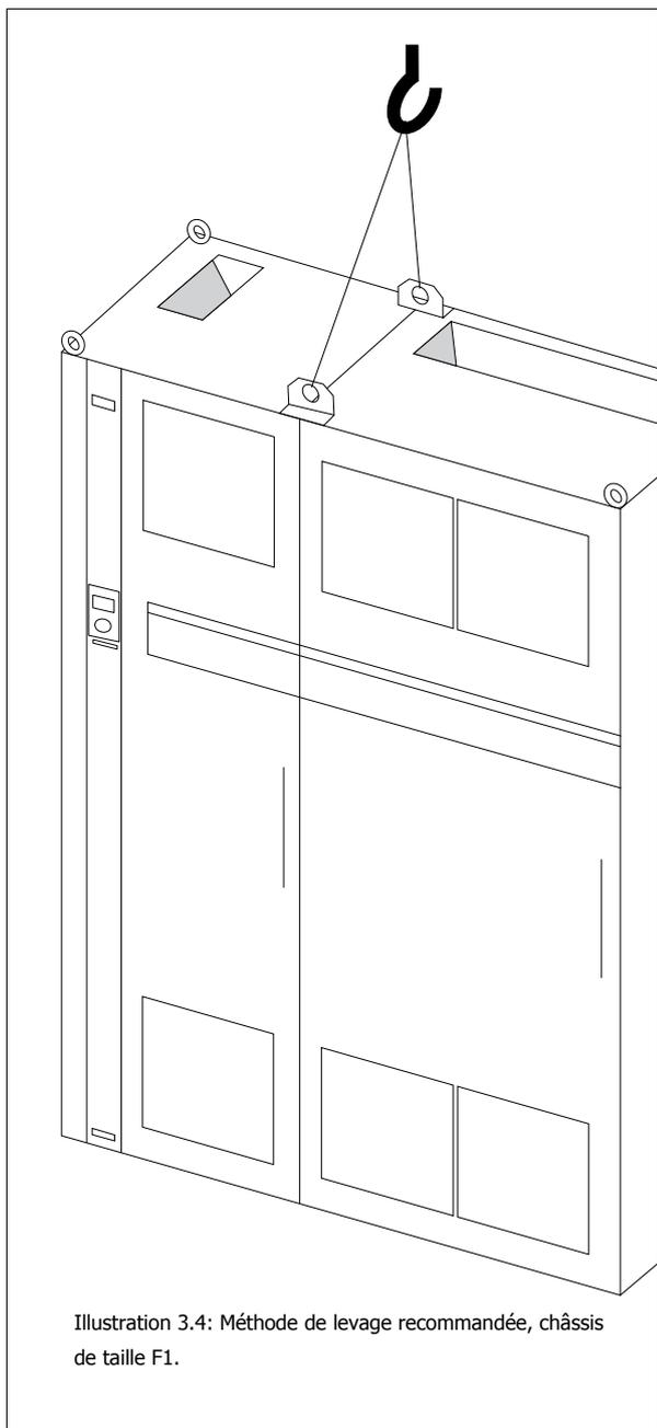
Illustration 3.4: Méthode de levage recommandée, châssis de taille F1.
