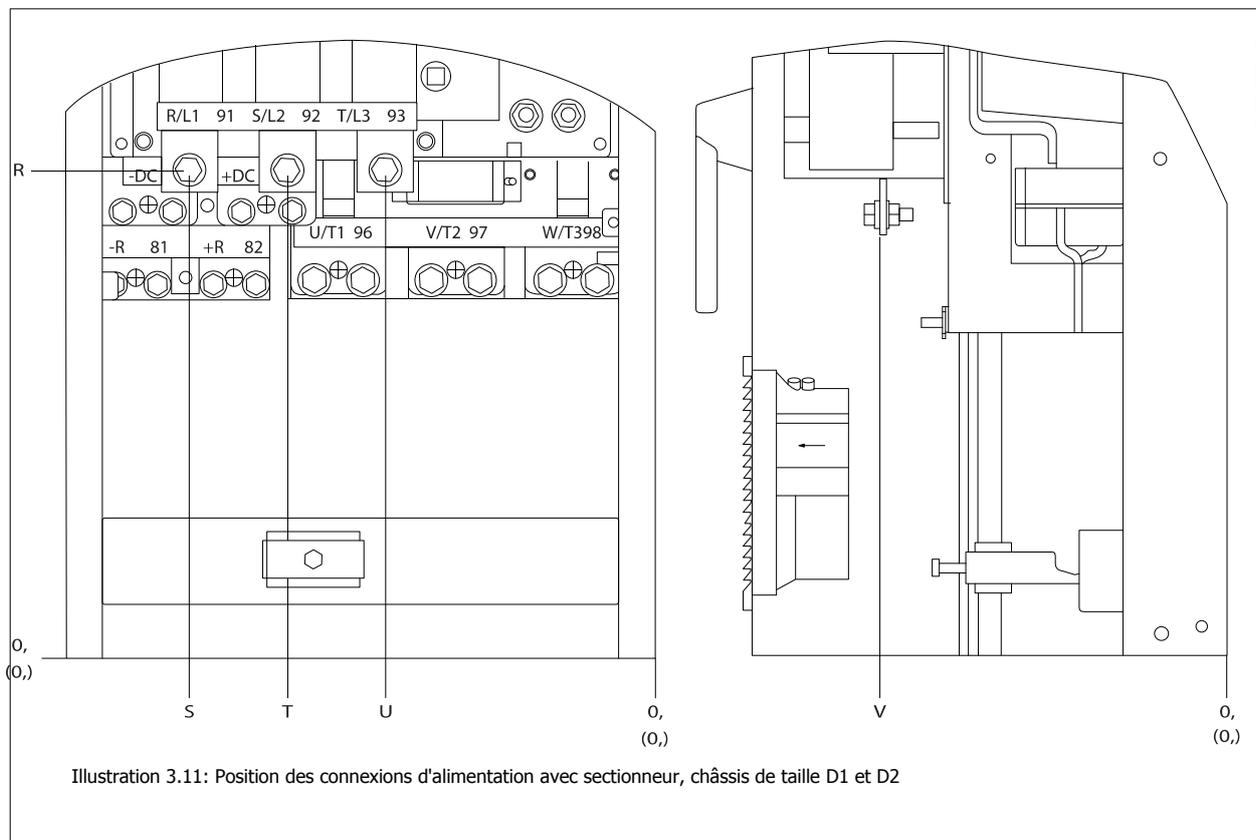
Noter que les câbles de puissance sont lourds et difficiles à plier. Considérer la position optimale du variateur de fréquence pour garantir une installation facile des câbles.
