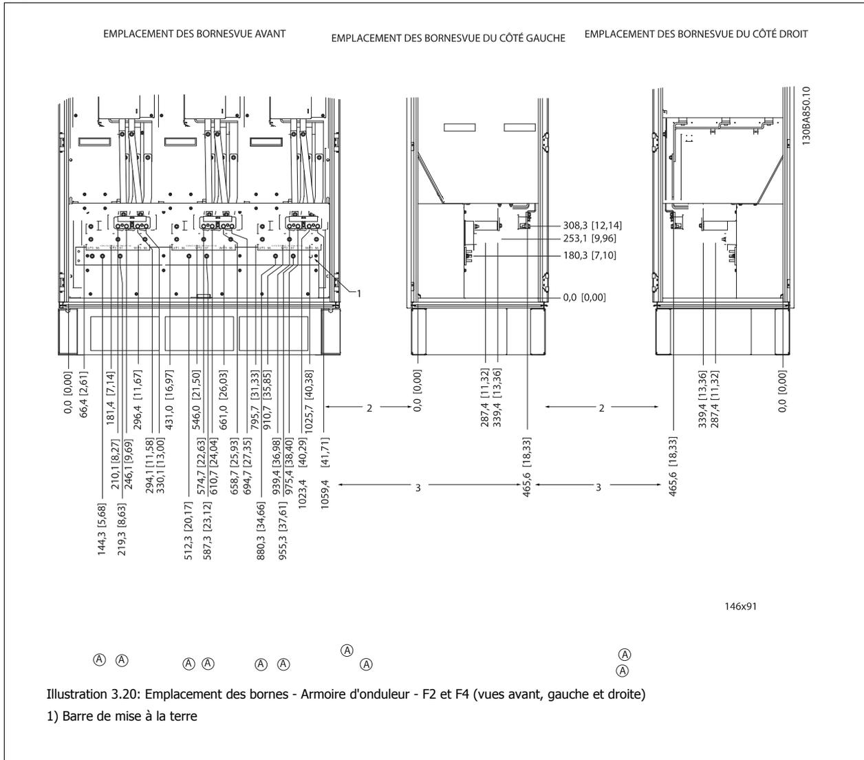
Illustration 3.20: Emplacement des bornes - Armoire d'onduleur - F2 et F4 (vues avant, gauche et droite)
