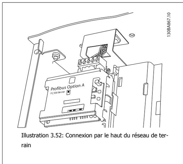
Illustration 3.52: Connexion par le haut du réseau de terrain
