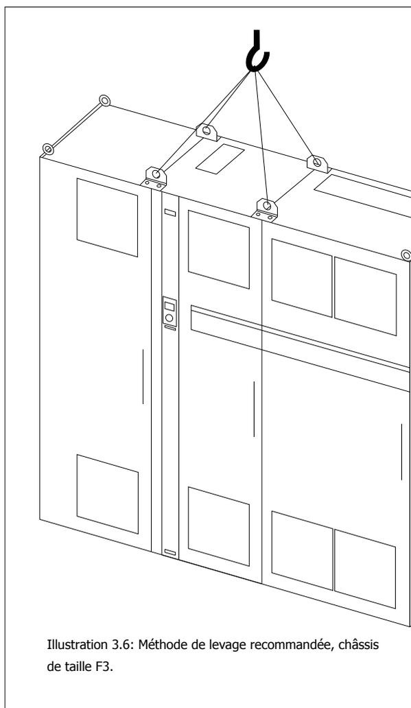
Illustration 3.6: Méthode de levage recommandée, châssis de taille F3.
