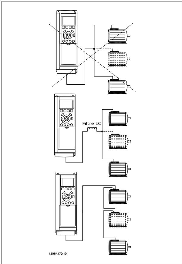
Des problèmes peuvent survenir au démarrage et à vitesse réduite, si les dimensions des moteurs sont très différentes, parce que la résistance ohmique relativement grande dans le stator des petits moteurs entraîne une tension supérieure au démarrage et à vitesse réduite.
