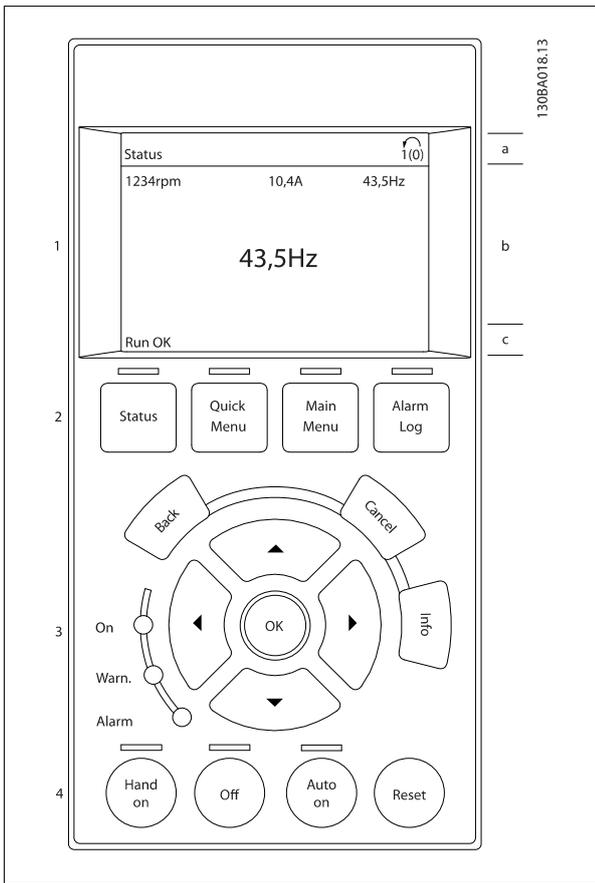
Le numéro du process actif (sélectionné comme Process actuel au par. 0-10) est indiqué. Lors de la programmation d'un process autre que le process actif, le numéro du process programmé apparaît à droite entre crochets.
