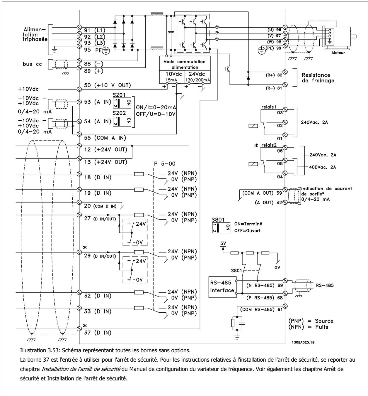
Les câbles de commande très longs et les signaux analogiques peuvent, dans des cas rares et en fonction de l'installation, provoquer des boucles de mise à la terre de 50/60 Hz, en raison du bruit provenant des câbles de l'alimentation secteur.
