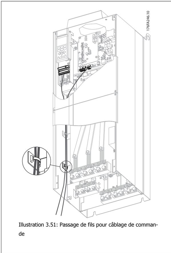
Dans les châssis (IP00) et les unités (NEMA 1), il est aussi possible de connecter le bus de terrain depuis le haut de l'unité comme indiqué sur l'illustration à droite. Sur l'unité NEMA 1, une plaque de finition doit être enlevée.
