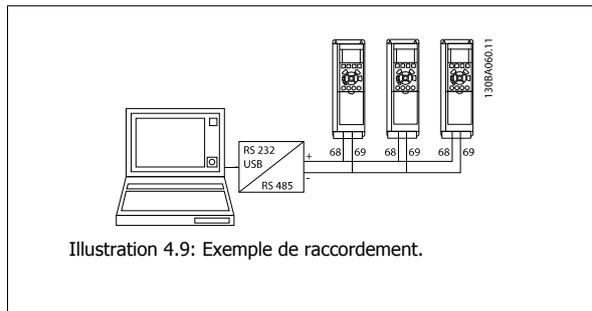
Afin d'éviter des courants d'égalisation de potentiel dans le blindage, relier celui-ci à la terre via la borne 61 reliée au châssis par une liaison RC.
