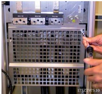
Disegno 3.50: Montaggio della schermatura EMC.
