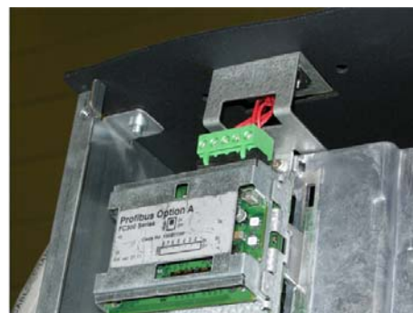
Ilustracja 3.52: Podłączenie magistrali komunikacyjnej w górnej części urządzenia.
