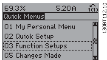
Ilustracja 5.4: Krok 3: Za pomocą przycisków nawigacji góra/dół przeglądać zestawy parametrów funkcji. Naciśnąć przycisk [OK].
