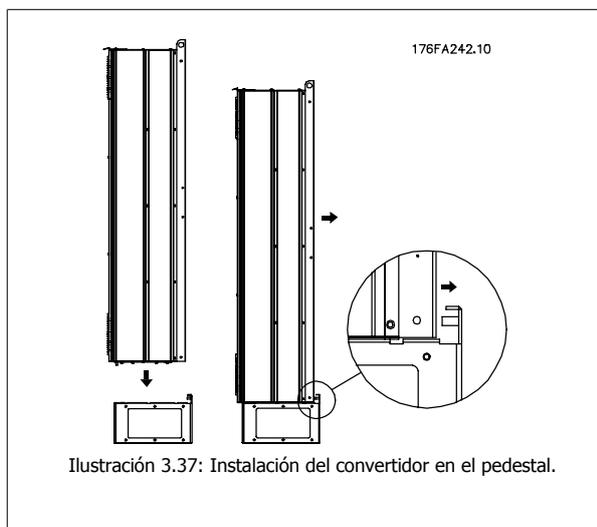
Ilustración 3.37: Instalación del convertidor en el pedestal.
