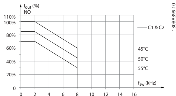
Illustration 5.17 Déclassement de I_{sortie} pour différentes T_{AMB} , MAX pour protections de tailles C1 et C2, utilisant SFAVM en mode de surcharge normale (surcouple de 110 %)
