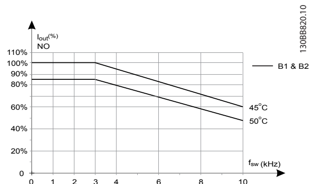
Bild 5.11 Nedstämpling för utström med switchfrekvens och omgivande temperatur för 600 V-frekvensomformare, kapslingsstorlek B, 60 AVM, NÖ
