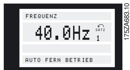
Zeile 2 zeigt die augenblickliche Ausgangsfrequenz und den aktiven Parametersatz (Setup) an.
