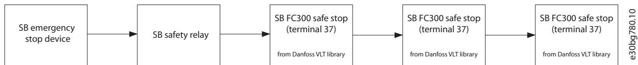
Ilustrasi 5.8 Diagram Blok terkait keselamatan
