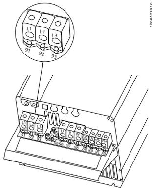
Abbildung 6.13 Netzanschluss Gehäusestyp C4 (IP20)
