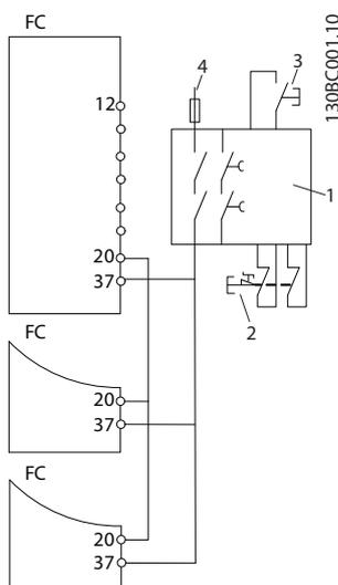
Abbildung 2.6 Beispiel für Parallelschaltung mehrerer Frequenzumrichter
