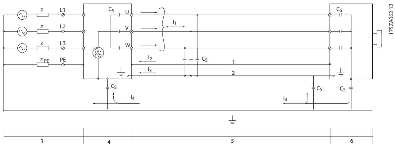
Abbildung 2.32 Situationen, in denen Ableitströme erzeugt werden
