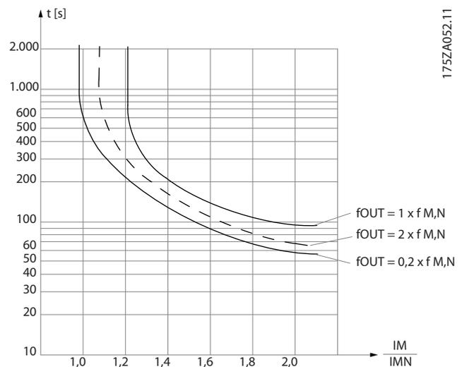
**Abbildung 2.40** Die X-Achse zeigt das Verhältnis zwischen  $I_{Motor}$  und  $Nenn-I_{Motor}$ . Die Y-Achse zeigt die Zeit in Sekunden, bevor ETR eingreift und den Frequenzumrichter abschaltet. Die Kurven zeigen die charakteristische Nenndrehzahl bei doppelter Nenndrehzahl und Nenndrehzahl x 0,2.
