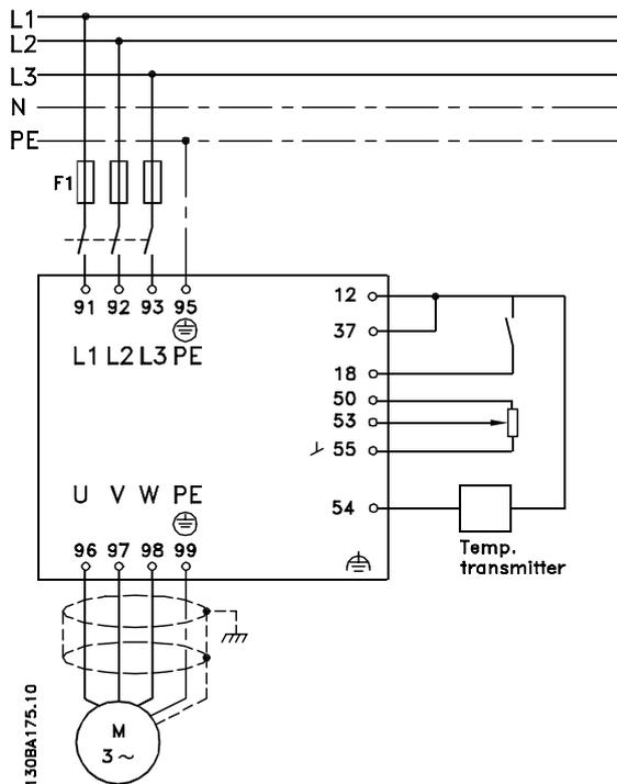
Abbildung 6.63 Elektrisches Anschlussdiagramm
