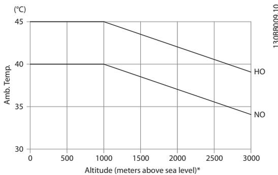
**Abbildung 9.26** Beispiel: Bei einer Höhe von 2000 m und einer Temperatur von 45 °C ( $T_{AMB, MAX} - 3,3 K$ ) sind 91 % des Ausgangsnennstroms verfügbar. Bei einer Temperatur von 41,7 °C sind 100 % des Ausgangsnennstroms verfügbar.
