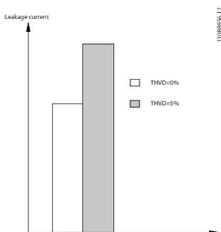
Abbildung 2.36 Einflüsse der Netzverzerrung auf den Ableitstrom
