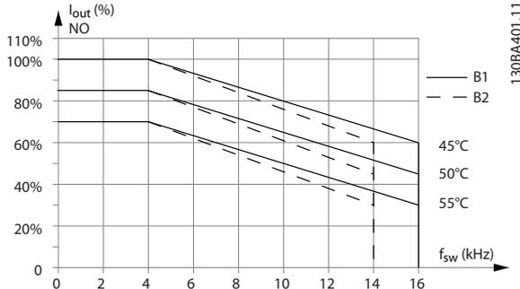
Abbildung 9.8 Leistungsreduzierung von  $I_{out}$  bei verschiedenen  $T_{AMB, MAX}$  bei Gehäusetypen B1 and B2 und Verwendung von 60° AVM im normalen Überlastmodus (110 % Übermoment)
