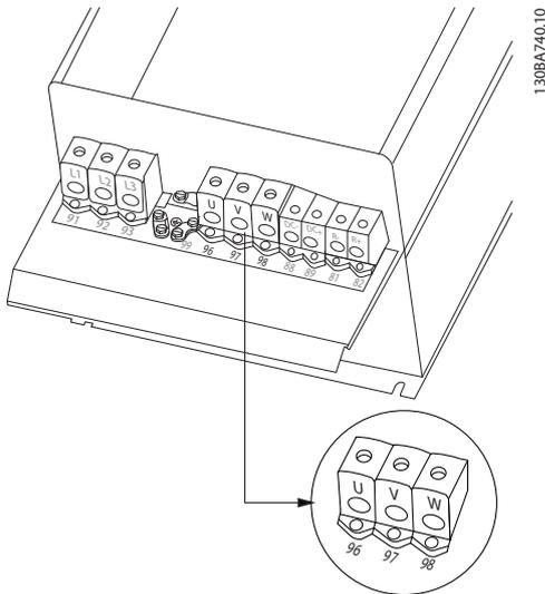
Abbildung 6.19 Motoranschluss bei Gehäuse Typ C3 und C4
