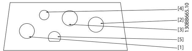
Abbildung 6.24 A4 - IP55 Kabeleinführungsöffnungen mit Gewinde
