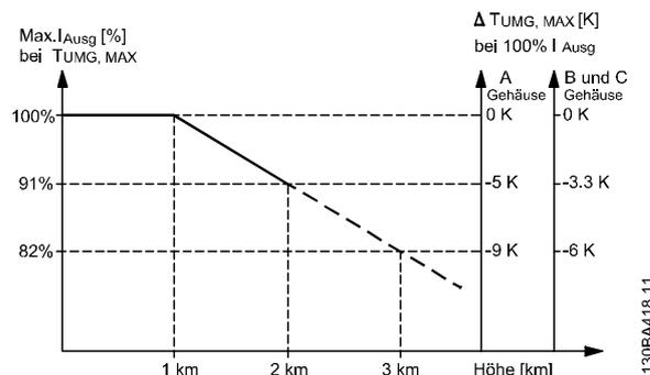
Abbildung 9.24 Höhenabhängige Ausgangsstromreduzierung bei T<sub>AMB, MAX</sub> bei Gehäusetypern A, B und C. Bei Höhen über 2000 m über NN ziehen Sie Danfoss zu PELV (Schutzkleinspannung) zurate.
