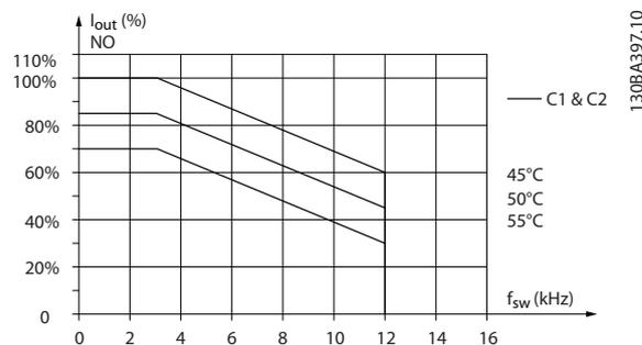
Abbildung 9.16 Leistungsreduzierung von Iout bei verschiedenen TAMB, MAX bei Gehäusotypen C1 and C2 und Verwendung von 60° AVM im normalen Überlastmodus (110 % Übermoment)
