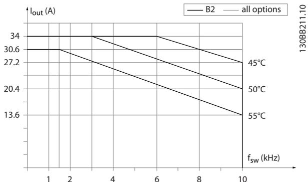
Abbildung 9.14 Ausgangsstromreduzierung mit Taktfrequenz und Umgebungstemperatur bei Gehäusotyp B2, 60° AVM. Achtung: Das Diagramm wird mit dem Strom als Absolutwert gezeichnet und gilt sowohl für hohe als auch normale Überlast.
