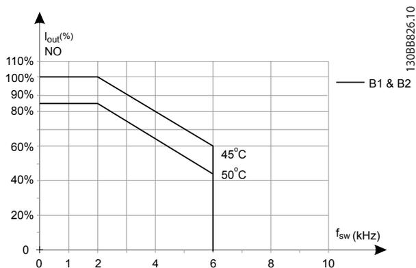
Abbildung 9.13 Ausgangsstromreduzierung mit Taktfrequenz und Umgebungstemperatur bei 600-V-Frequenzumrichtern, Gehäusotyp B, SFAVM, NO
