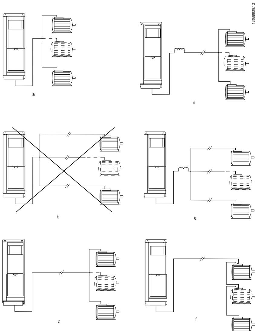
Abbildung 6.41 Parallel Motoranschluss
