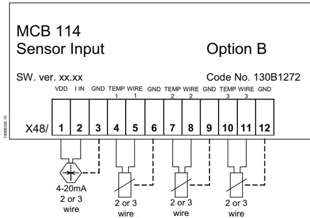
Abbildung 3.15 Elektrische Verdrahtung
