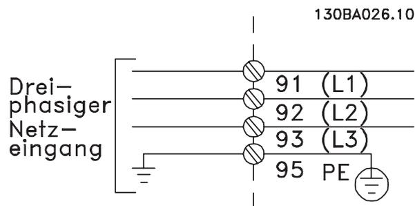
Abbildung 6.1 Netzanschluss
