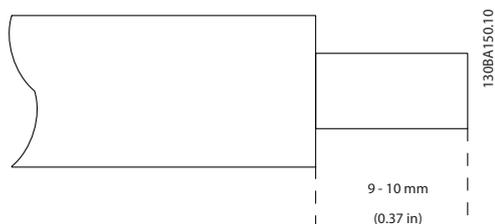
Abbildung 6.50 Kabel abisolieren
