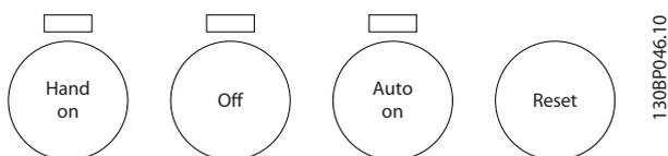
Abbildung 2.25 Bedientasten
