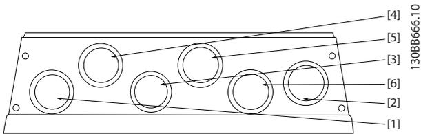
Abbildung 6.26 A5 - IP55 Kabeleinführungsöffnungen mit Gewinde
