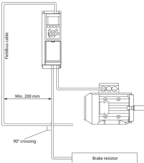
Abbildung 8.4 Kabelverlegung
