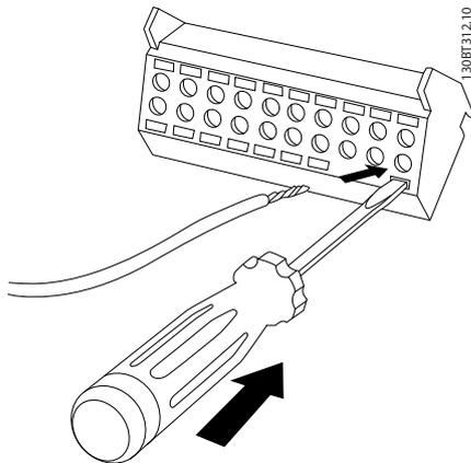
Abbildung 6.51 Schraubendreher einführen
