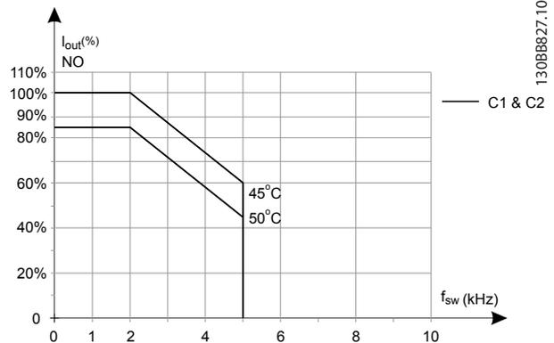
Abbildung 9.21 Ausgangsstromreduzierung mit Taktfrequenz und Umgebungstemperatur bei 600-V-Frequenzumrichtern, Gehäusety C, SFAVM, NO
