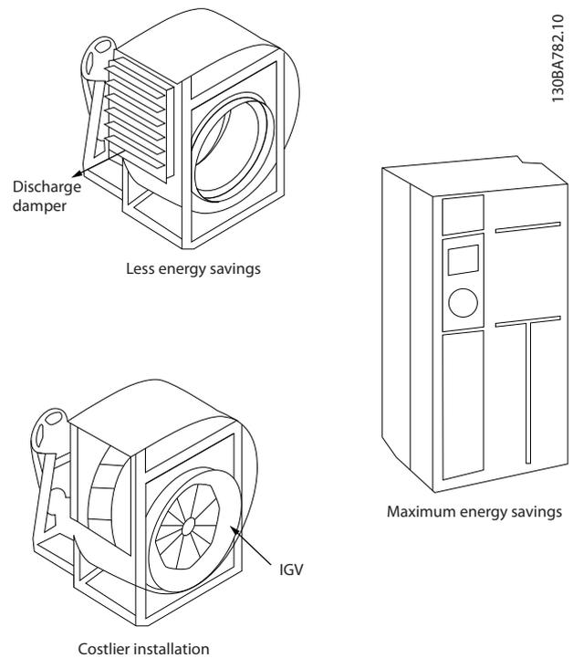
Abbildung 2.11 Die 3 häufigsten Systeme zur Einsparung von Energie
