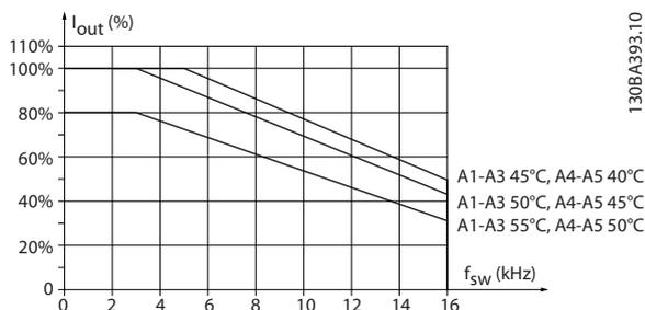
Abbildung 9.3 Leistungsreduzierung von  $I_{out}$  bei verschiedenen  $T_{AMB, MAX}$  bei Gehäusetyp A und Verwendung von 60° AVM
