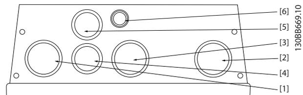
Abbildung 6.29 B1 - IP55 Kabeleinführungsöffnungen mit Gewinde
