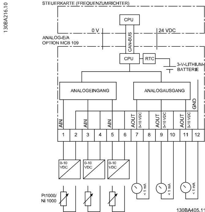
Abbildung 3.12 Prinzipschaltbild für im Frequenzumrichter integrierte analoge I/O
