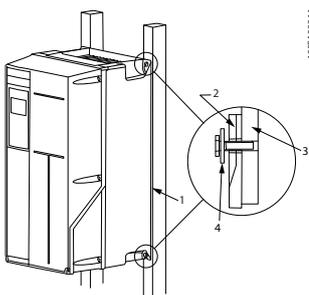
Abbildung 5.5 Montage an einer nicht stabilen Rückwand
