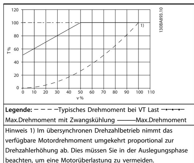
**Tabelle 9.33** Maximale Last eines Standardmotors bei 40 °C
