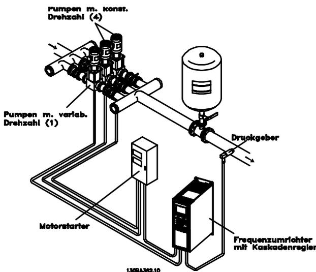
Abbildung 7.7 Eine Pumpenanwendung
