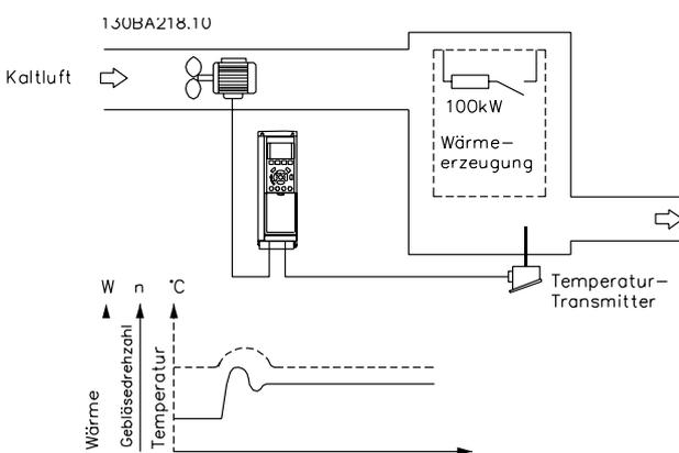
Abbildung 2.30 Regelung mit Rückführung bei einer Lüftungsanlage
