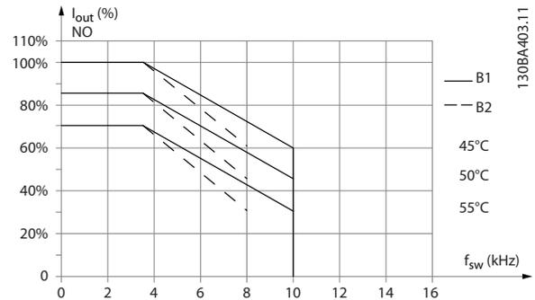
Abbildung 9.10 Leistungsreduzierung von  $I_{out}$  bei verschiedenen  $T_{AMB, MAX}$  bei Gehäusetypen B1 and B2 und Verwendung von SFAVM im normalen Überlastmodus (110 % Übermoment)
