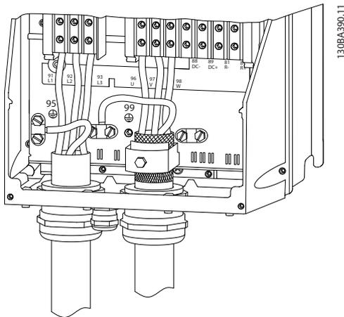
Abbildung 6.18 Motoranschluss Gehäuse Typ C1 und C2 (IP21 und IP55/66)
