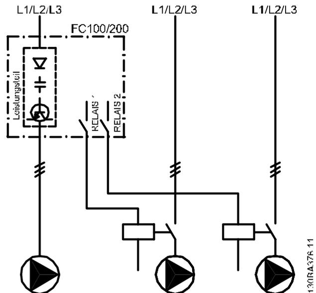
Abbildung 7.9 Schaltbild für Pumpe mit konstanter/variabler Drehzahl
