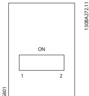
Abbildung 8.3 Werkseinstellung des Schalters für den Abschlusswiderstand
