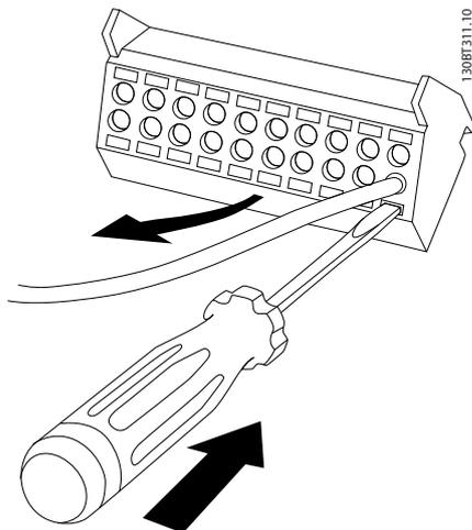
Abbildung 6.52 Kabel einführen
