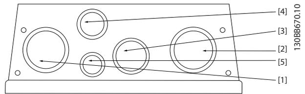
Abbildung 6.32 B2 - IP55 Kabeleinführungsöffnungen mit Gewinde
