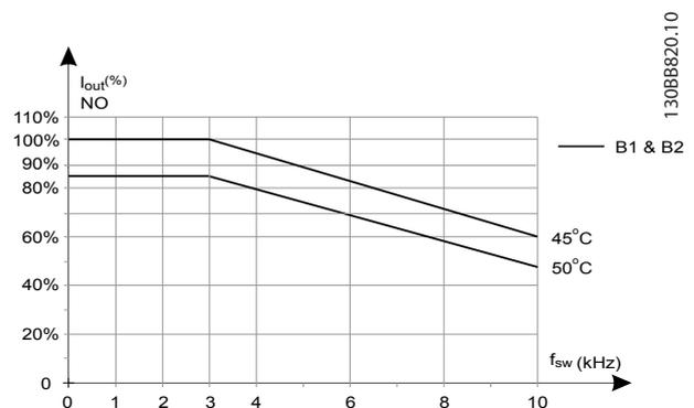
Abbildung 9.12 Ausgangsstromreduzierung mit Taktfrequenz und Umgebungstemperatur bei 600-V-Frequenzumrichtern, Gehäusetyp B, 60 AVM, NO
