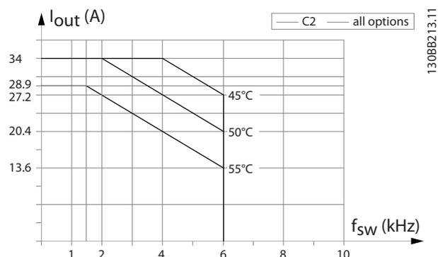
Abbildung 9.22 Ausgangsstromreduzierung mit Taktfrequenz und Umgebungstemperatur bei Gehäusetyp C2, 60° AVM. Achtung: Das Diagramm wird mit dem Strom als Absolutwert gezeichnet und gilt sowohl für hohe als auch normale Überlast.
