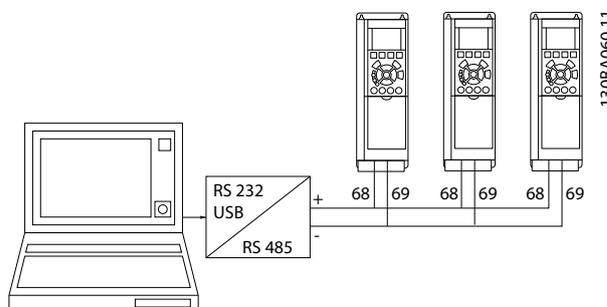
Abbildung 8.1 Parallele Verdrahtung
