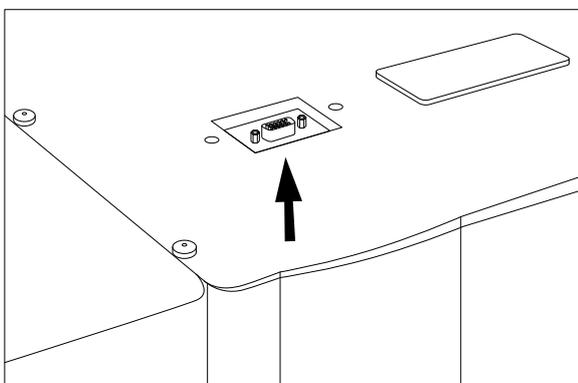
Abbildung 6.46 Anschluss von oben für Feldbus bei IP00
