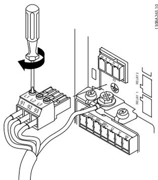
Abbildung 6.4 Montage von Netzstecker und Anziehen der Kabel
