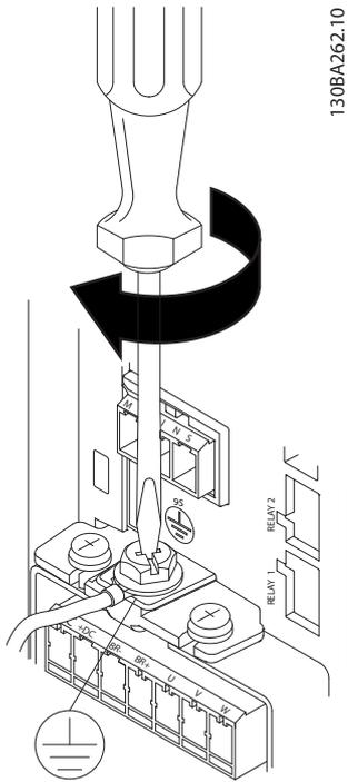
Abbildung 6.3 Anziehen des Erdkabels
