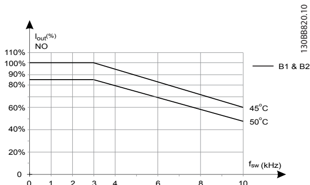
Illustration 9.12 Déclassement du courant de sortie avec fréquence de commutation et température ambiante pour variateurs de fréquence de 600 V, protection de type B, 60° AVM, NO
