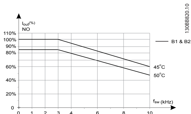
Illustration 5.11 Derating af udgangsstrøm med switchfrekvens og omgivelsestemperatur for 600 V-frekvensomformere, kapslingsstørrelser B, 60 AVM, NO
