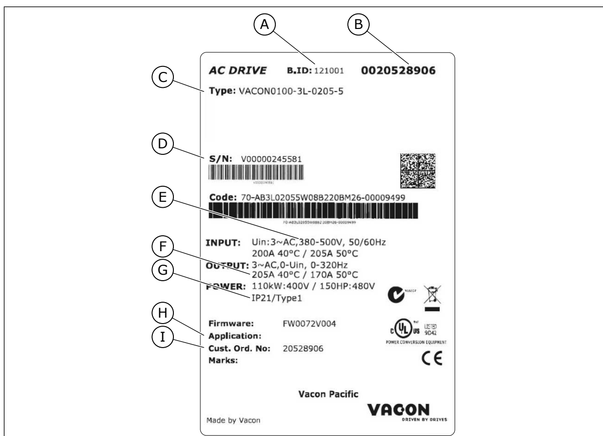
Fig. 1: Étiquette d'emballage des convertisseurs de fréquence Vacon
