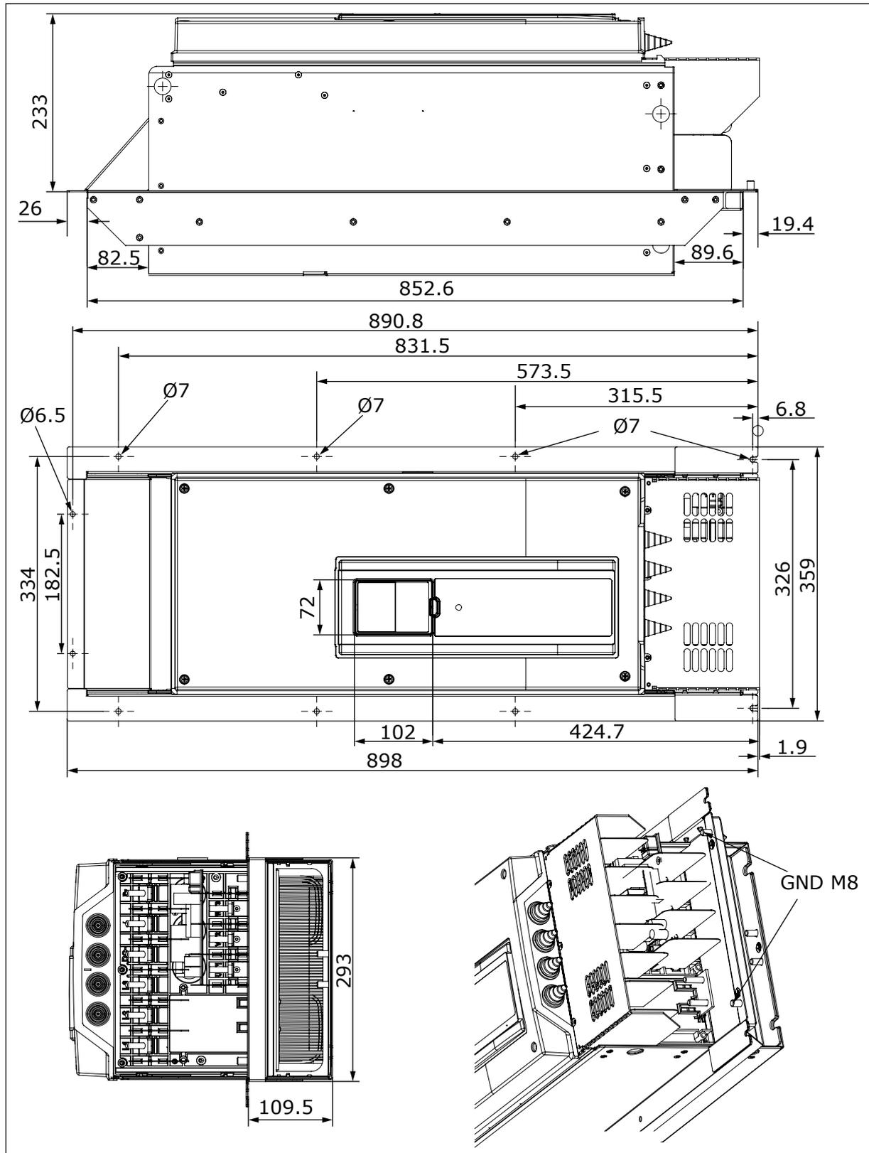
Fig. 25: Dimensioni dell'inverter, montaggio a flangia, MR8 [mm]
