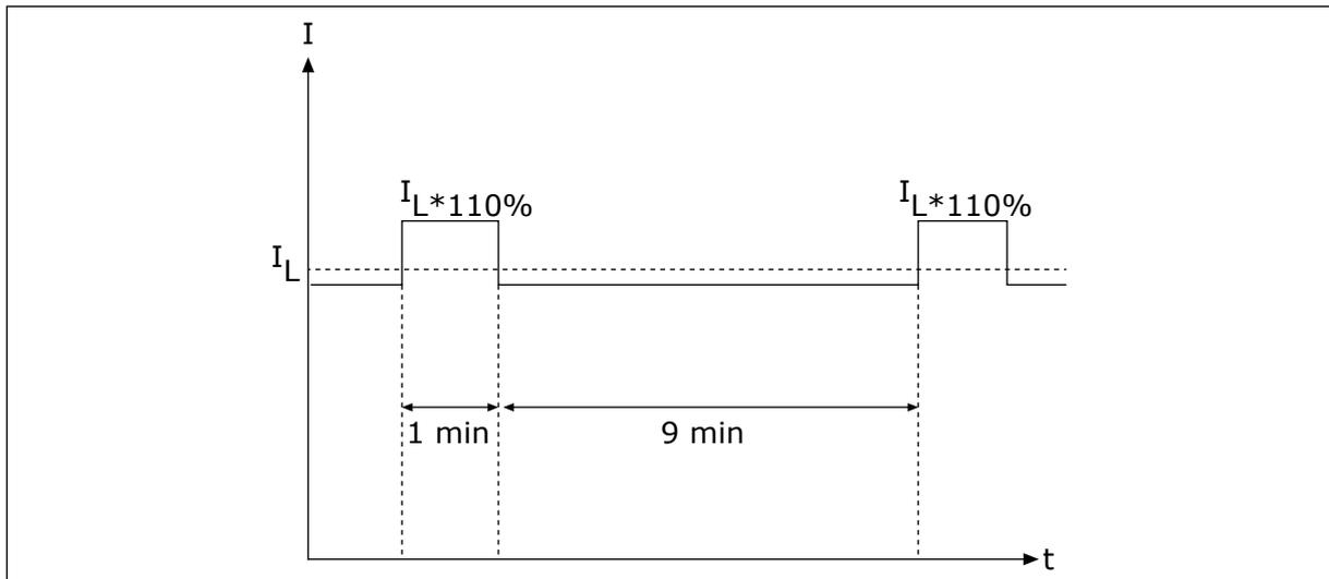
Fig. 50: Sovraccarico basso in Vacon® 100 FLOW
