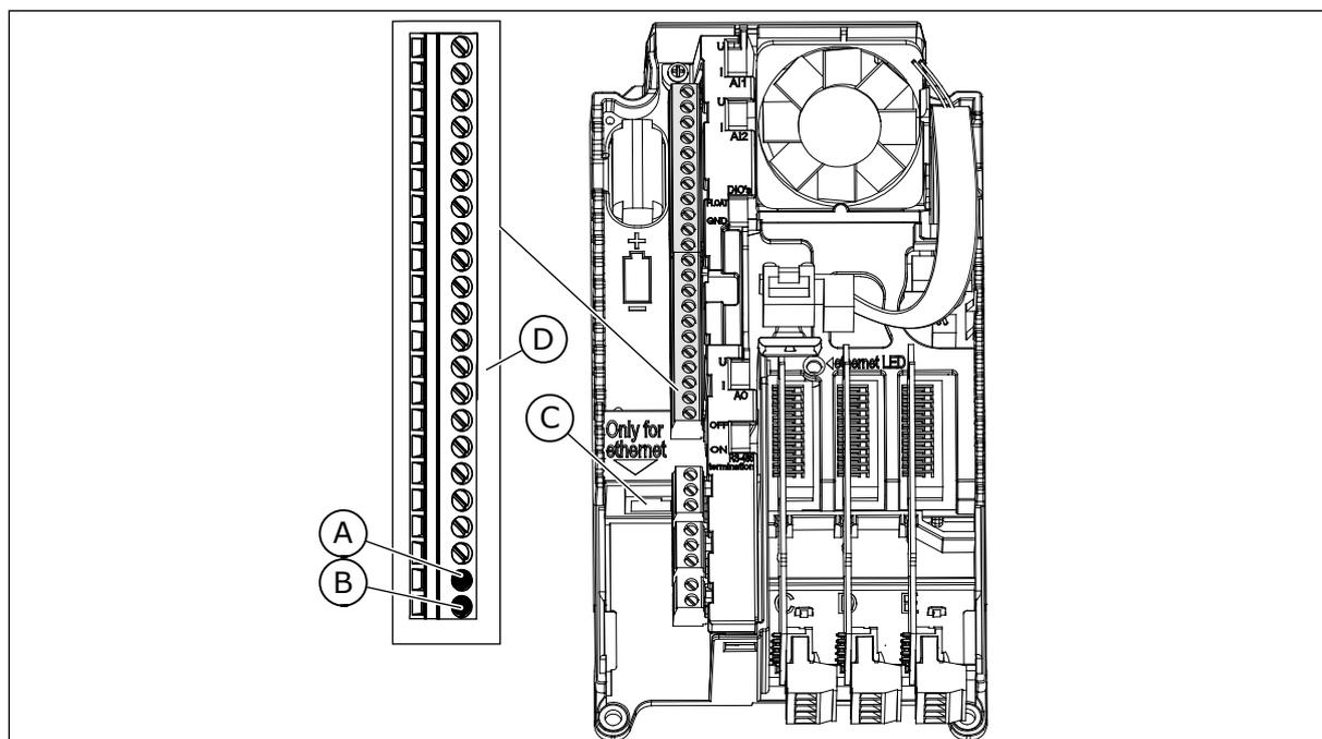
Fig. 44: Collegamenti Ethernet e RS485
