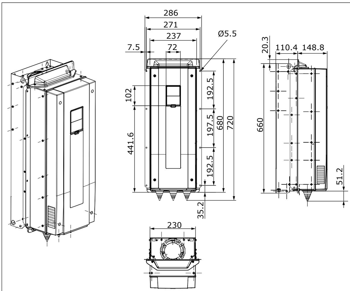
Fig. 24: Dimensioni dell'inverter, montaggio a flangia, MR7 [mm]
