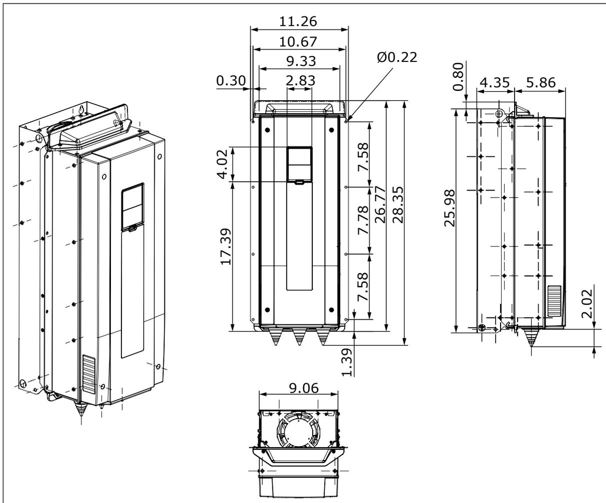
Fig. 30: Dimensioni dell'inverter, montaggio a flangia, MR7 [pollici]
