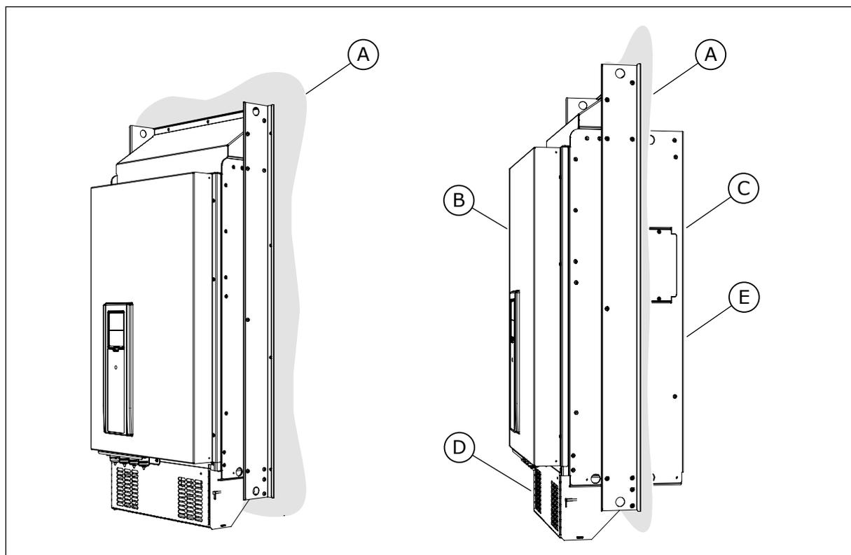
*Fig. 18: Esempio di montaggio a flangia (MR9)*
