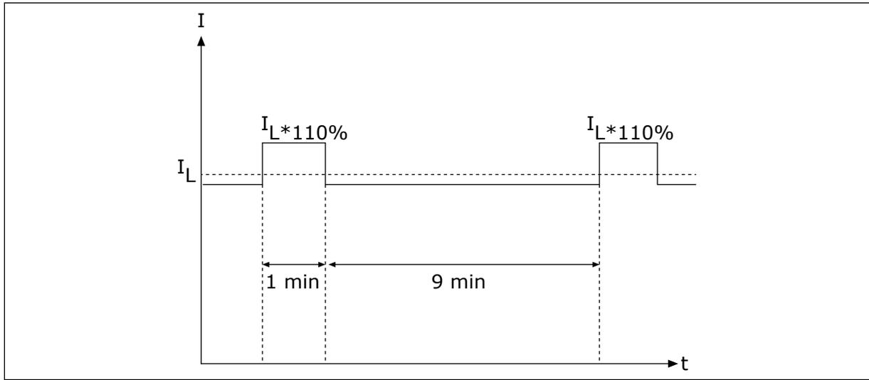
Fig. 51: Sovraccarico basso in Vacon® 100 HVAC
