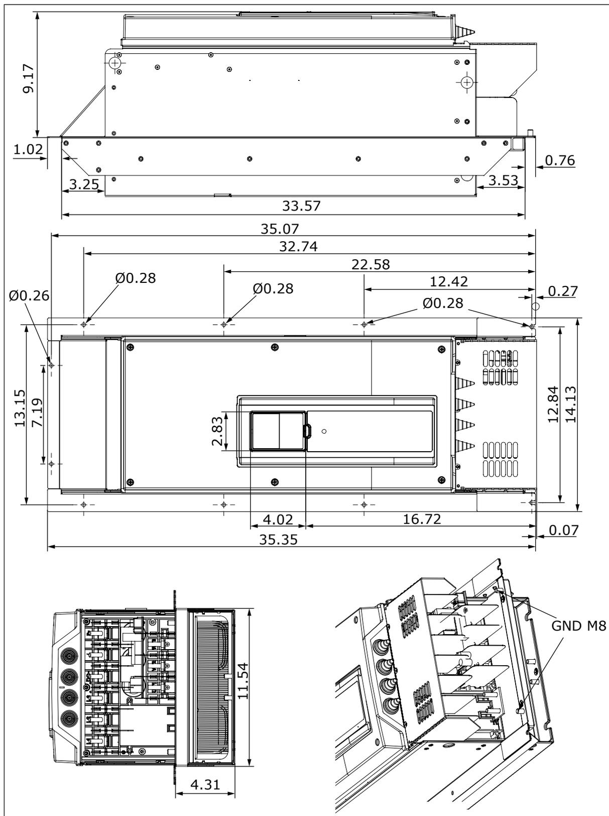
Fig. 31: Dimensioni dell'inverter, montaggio a flangia, MR8 [pollici]
