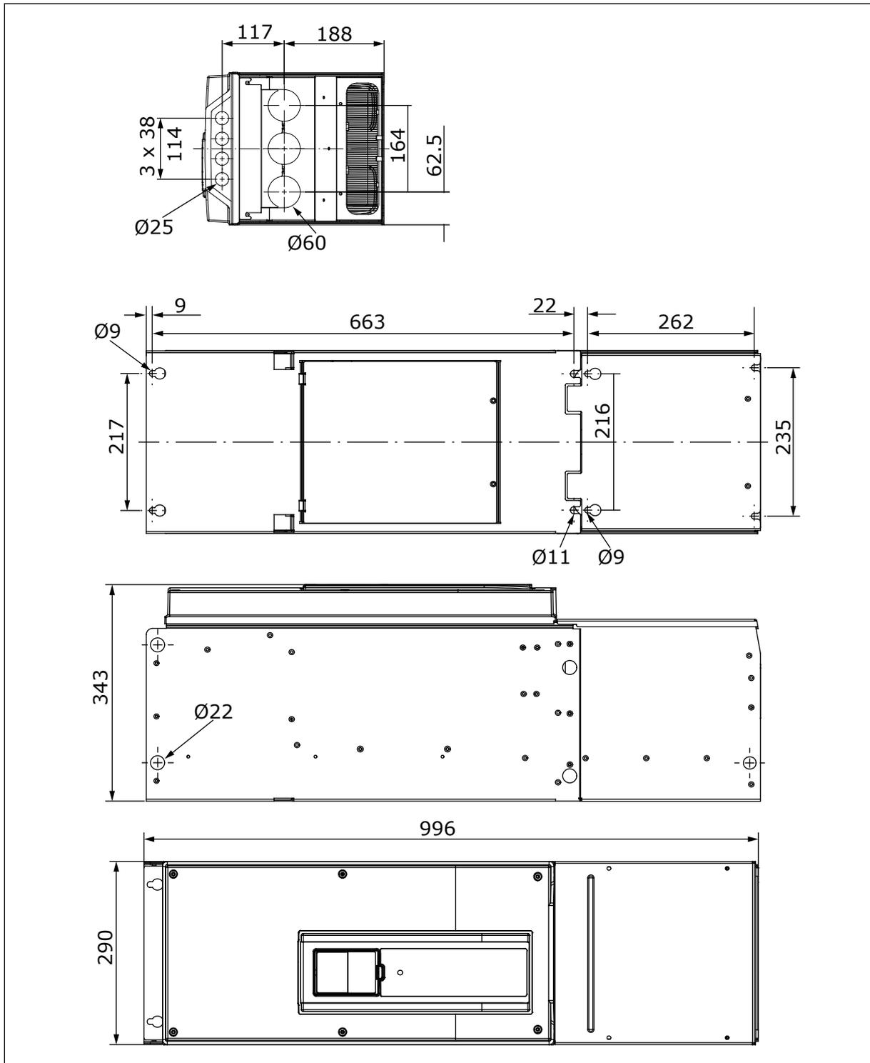
Fig. 6: Dimensioni dell'inverter, MR8, IP21 e IP54 [mm]
