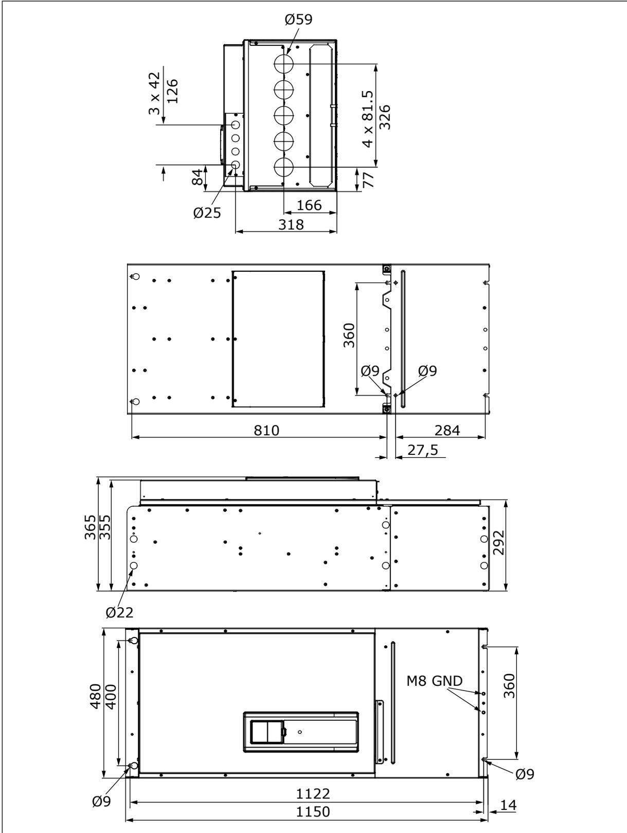
Fig. 8: Dimensioni dell'inverter, MR9, IP21 e IP54 [mm]
