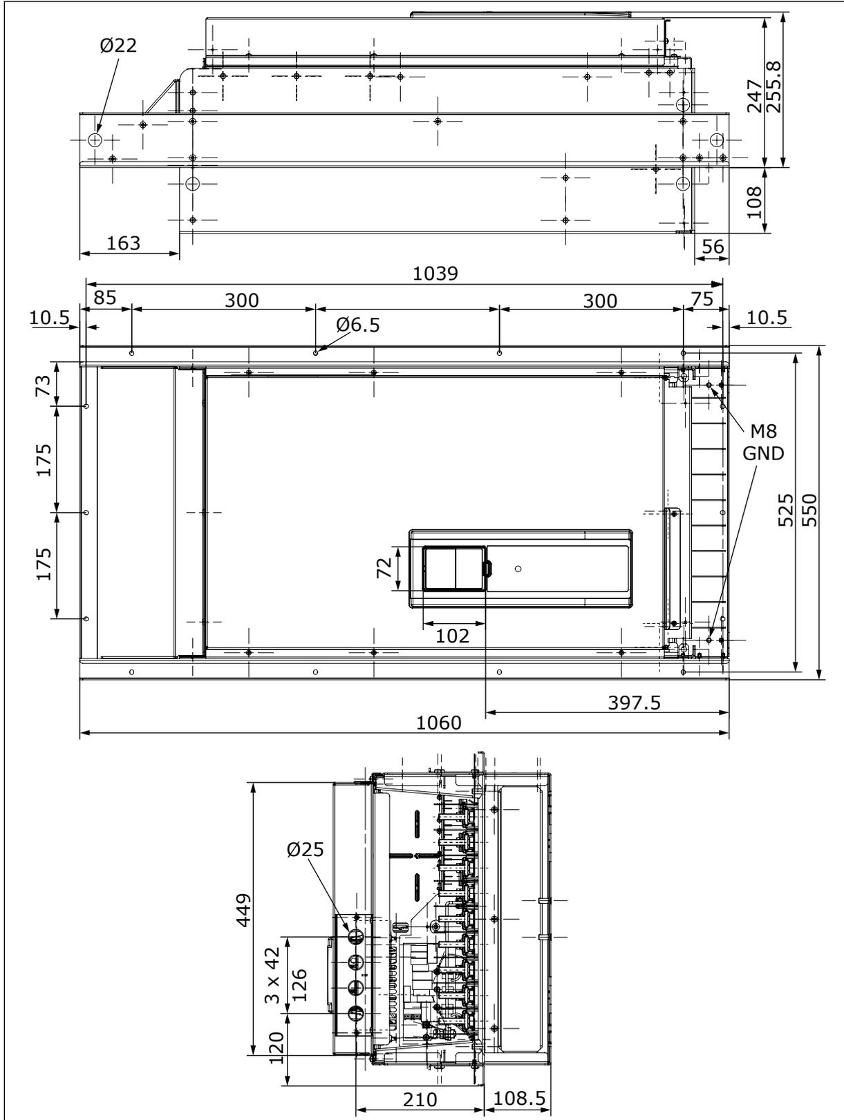
Fig. 26: Dimensioni dell'inverter, montaggio a flangia, MR9 [mm]
