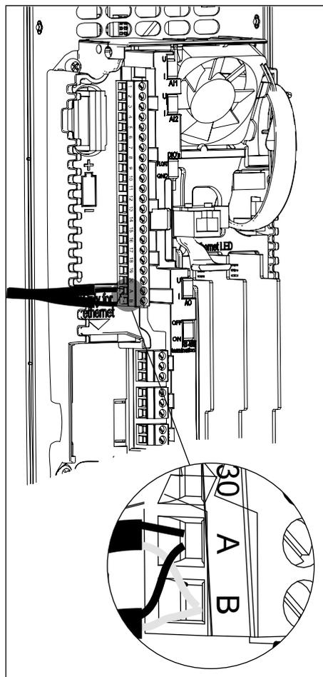
3 Fissare la schermatura del cavo al telaio dell'inverter con una fascetta di terra per il cavo di controllo in modo da eseguire il collegamento di terra.
