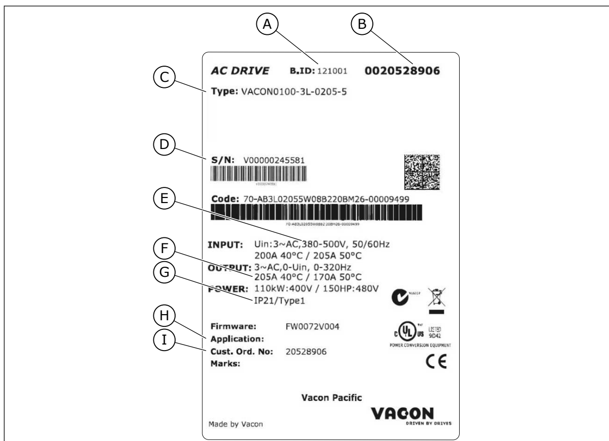
Rys. 1: Etykieta na opakowaniu przemienników częstotliwości Vacon
