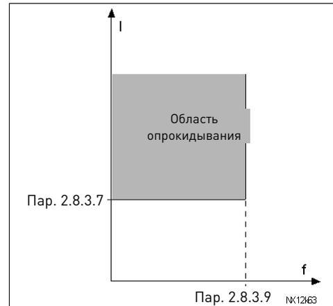
Рис. 20. Границы области опрокидывания
