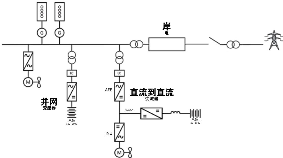
图2 船用交流电网示例，包括直流储能器和岸电。
