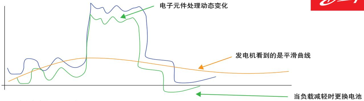
图4 由电气存储系统处理突变。
