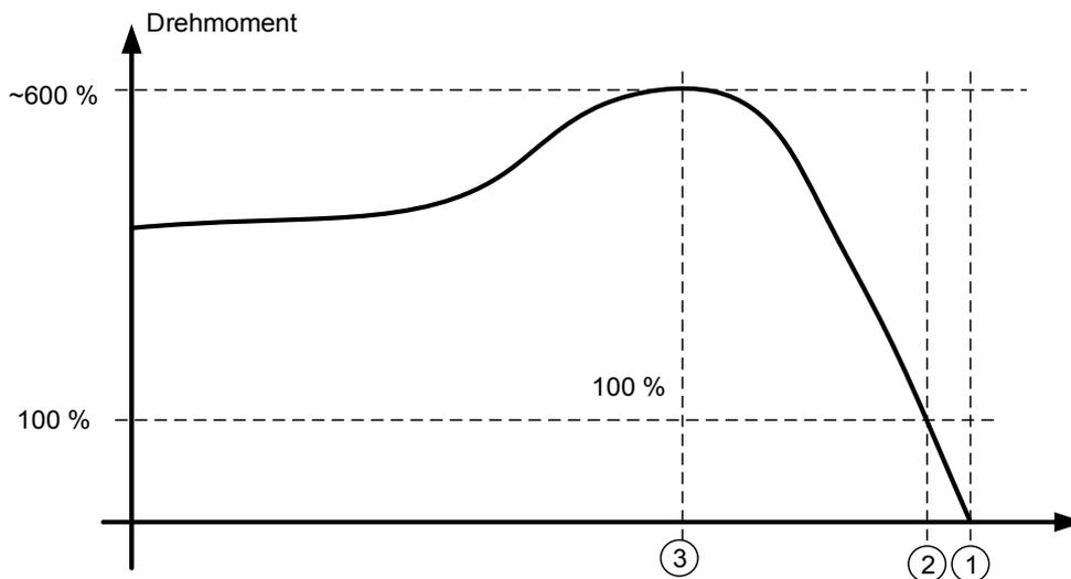
Bei der Frequenzregelung bestimmt die Last die Ist-drehzahl der Welle.
