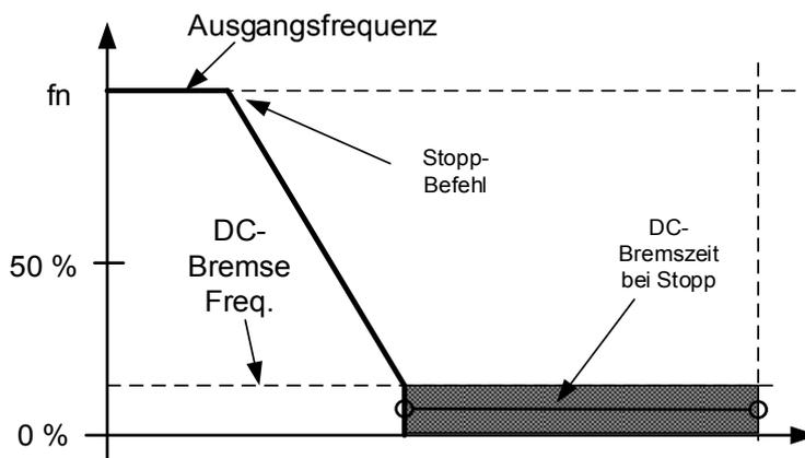
Bild 715. DC-Bremszeit im Stopp-Modus = Rampe
