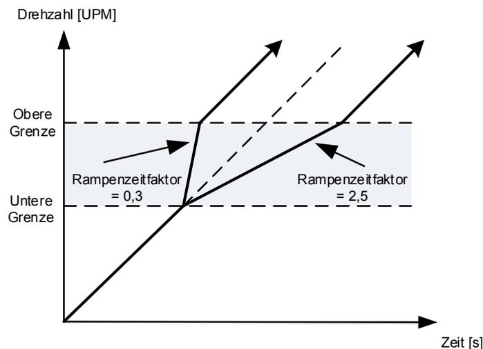
Bild 7-1. Rampen-Geschwindigkeits-Skalierung zwischen den Frequenzausblendungsgrenzen
