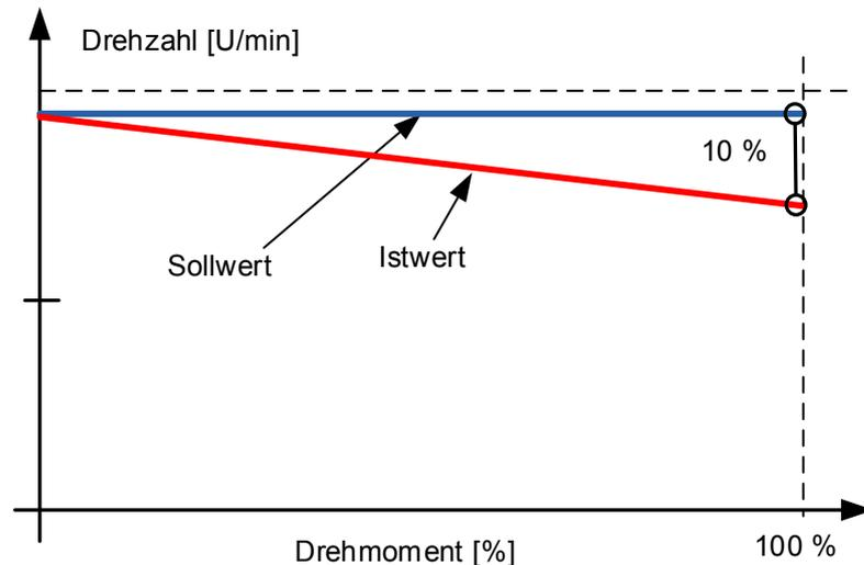
Beispiel: Wenn Load Drooping auf 10 % eingestellt ist, und ein Motor mit einer Nennfrequenz von 50 Hz mit Nennlast (100 % Drehmoment) betrieben wird, darf die Ausgangsfrequenz um 5 Hz vom Frequenzsollwert abfallen. Die Funktion wird z. B. verwendet, wenn bei mechanisch angeschlossenen Motoren eine symmetrische Last benötigt wird.
