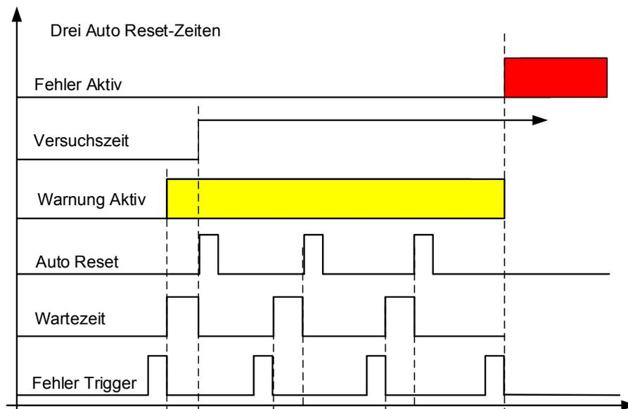
Bild 7-18. Beispiel für automatische Neustarts mit drei Neustarts
