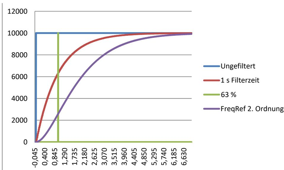
Bild 7-10. AI1-Signal-Filterung
