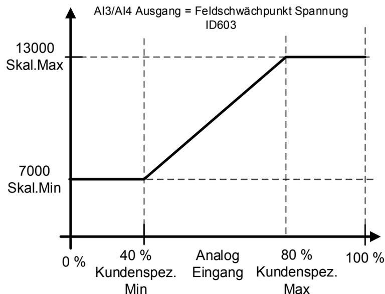
Nun steuert das Analogeingangssignal 3 0 V bis 10 V (0 mA bis 20 mA) die Feldschwächpunktspannung zwischen 70,00 % und 130,00 %. Bei der Einstellung des Wertes ist zu beachten, dass Dezimalstellen als ganze Zahlen behandelt werden.
