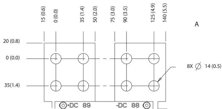
Slika 5.15 Dimenzije priključaka za raspodelu opterećenja/rekuperaciju kućišta E4h
