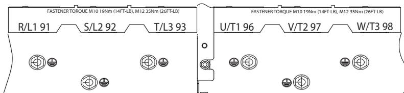
Slika 5.5 Priklučki uzemljenja (prikazano je kućište E1h). Detaljni prikaz priključaka navodi *poglavlje 5.7 Dimenzije priključaka*
