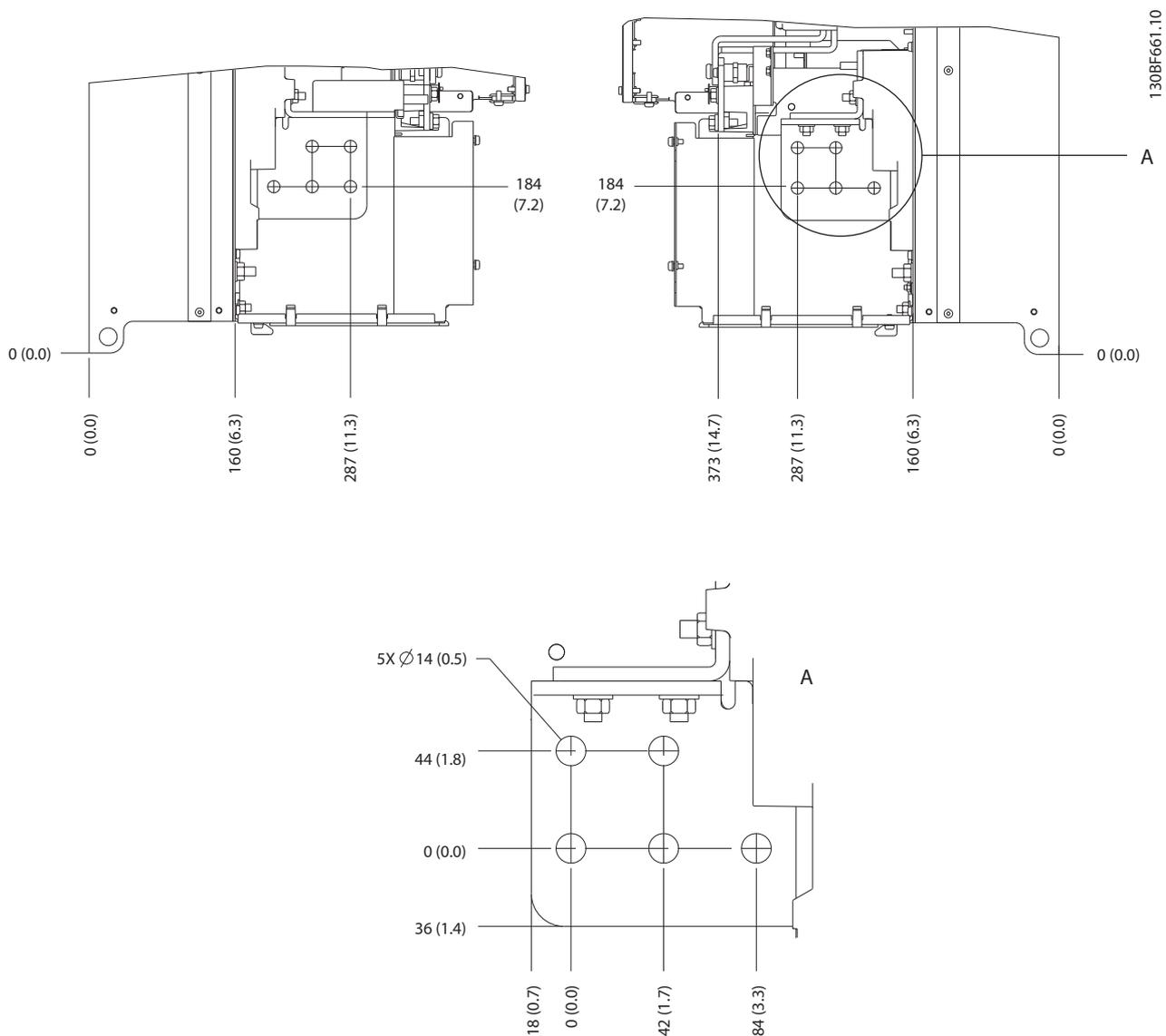
Slika 5.11 Dimenzije priključaka mrežnog napajanja, motora i uzemljenja kućišta E3h (prikazi bočne strane)
