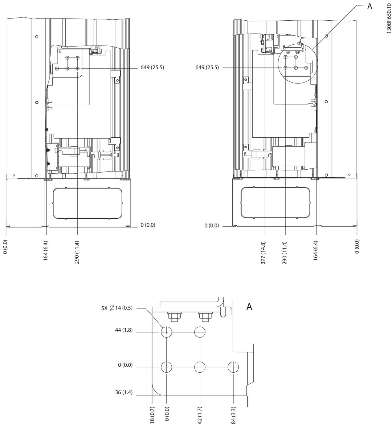
Slika 5.7 Dimenzije priključaka kućišta E1h (prikazi bočne strane)
