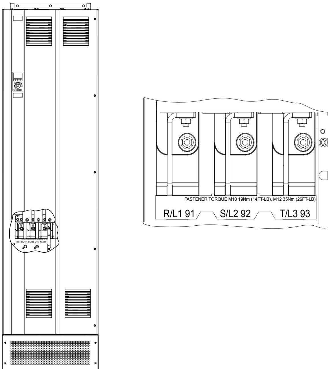
Slika 5.4 Priklučci mrežnog napajanja naizmjeničnom strujom (prikazano je kućište E1h). Detaljni prikaz priključaka navodi poglavlje 5.7 Dimenzije priključaka
