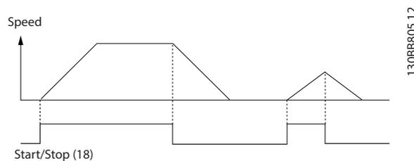
Slika 7.2 Komanda za start/stop sa Safe Torque Off
