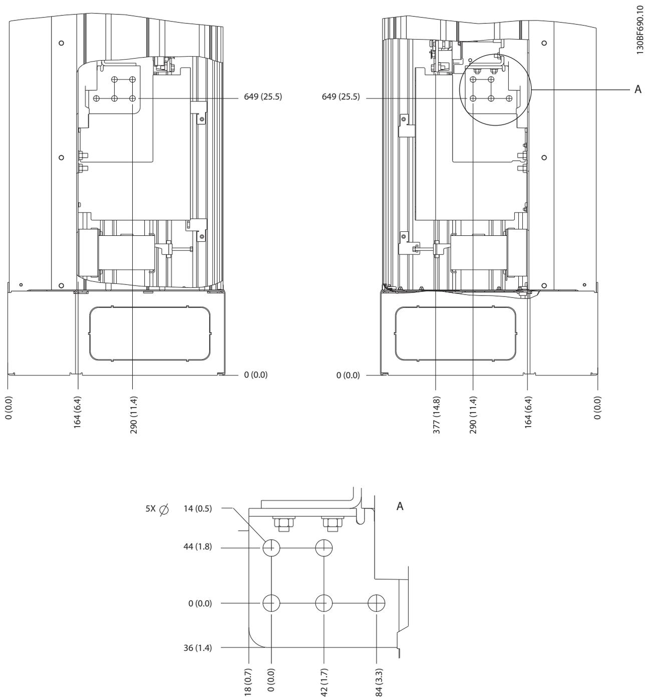
Slika 5.9 Dimenzije priključaka kućišta E2h (prikazi bočne strane)
