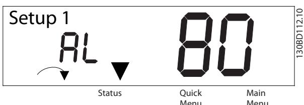
Slika 8.2 Alarm/Poništenje pogreške zaključano
