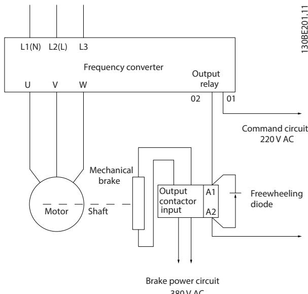
Slika 4.11 Povezivanje mehaničke kočnice s frekvencijskim pretvaračem
