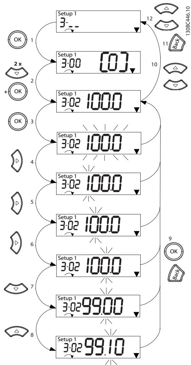
**Slika 5.5 Interakcije unutar glavnog izbornika – neprekidni parametri**
