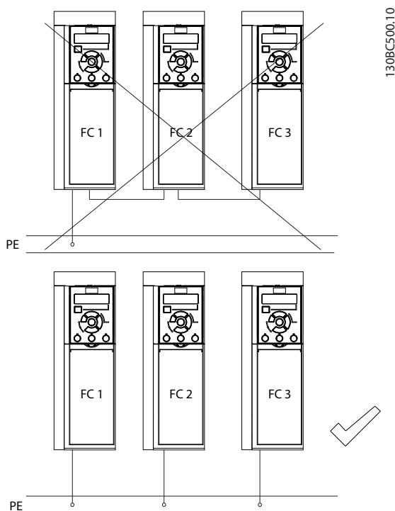
Slika 4.1 Princip uzemljenja
