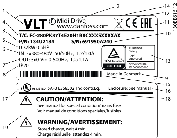
Slika 3.1 Natpisna pločica proizvoda (primjer)
