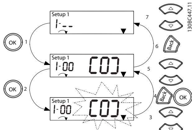
Slika 5.6 Interakcije unutar glavnog izbornika – numerički parametri
