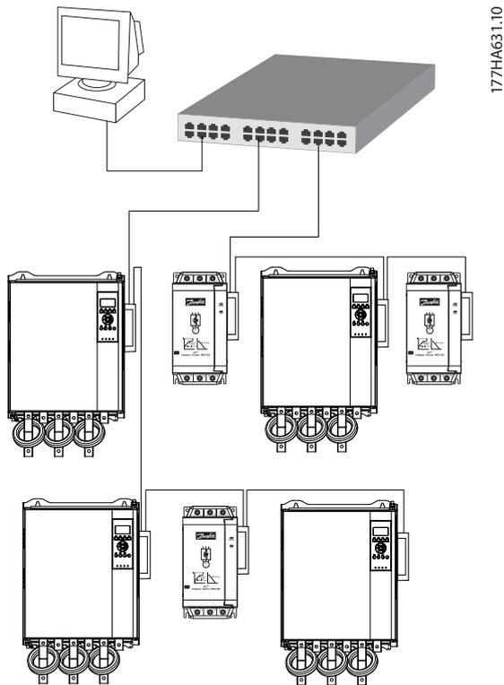
Abbildung 8.4 Kombinierte Stern/Reihen-Netzwerktopologie
