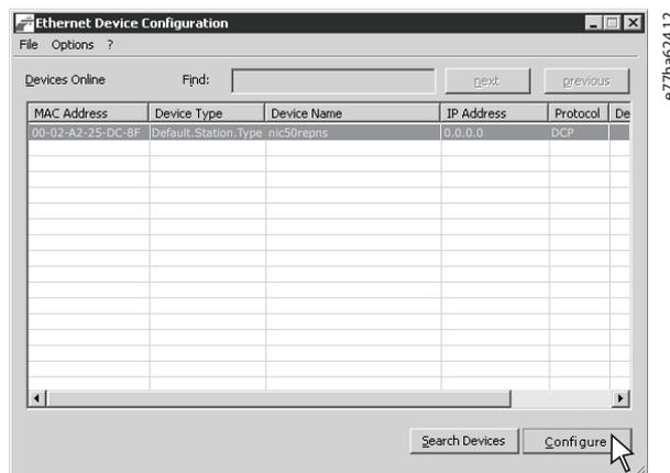
Ilustración 5.2 La herramienta muestra los dispositivos conectados
