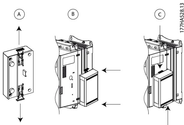
Ilustración 3.1 Instalación del módulo PROFINET
