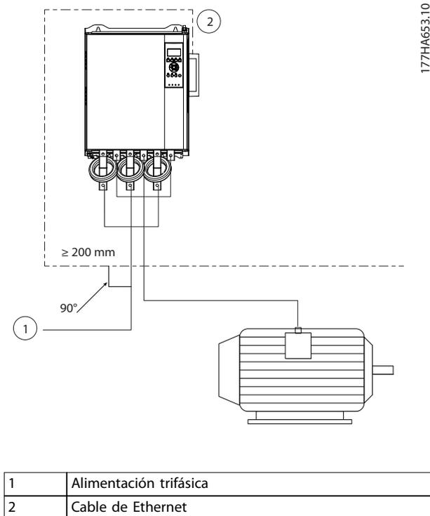
Ilustración 4.1 Tendido correcto de los cables de Ethernet
