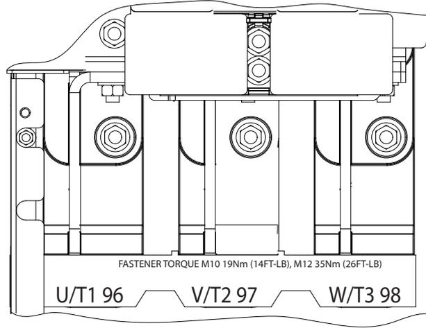
Çizim 5.3 AC motor terminalleri (E1h gösteriliyor). Terminallerin detaylı görünümü için bkz. bölüm 5.7 Terminal Boyutları
