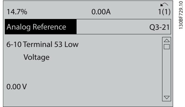
Çizim 6.8 Parametre 6-10 Terminal 53 Düşük Voltaj
