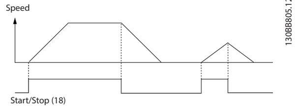
Çizim 7.2 Safe Torque Off ile Başlatma/Durdurma Komutu
