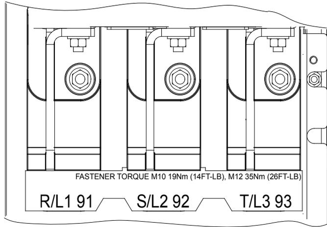
Çizim 5.4 AC şebeke terminalleri (E1h gösteriliyor). Terminallerin detaylı görünümü için bkz. bölüm 5.7 Terminal Boyutları
