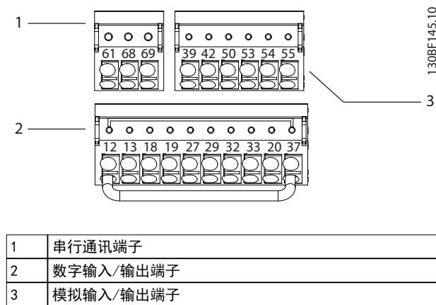
图 10.7 连接器上的的端子号
