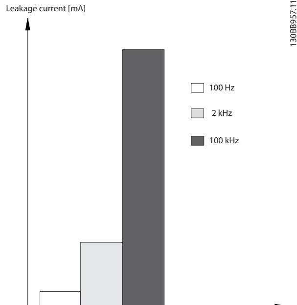
图 10.15 RCD 截止频率对漏电电流的影响
