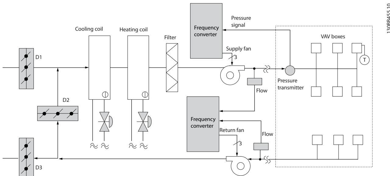
图 5.16 变风量系统中使用的变频器
