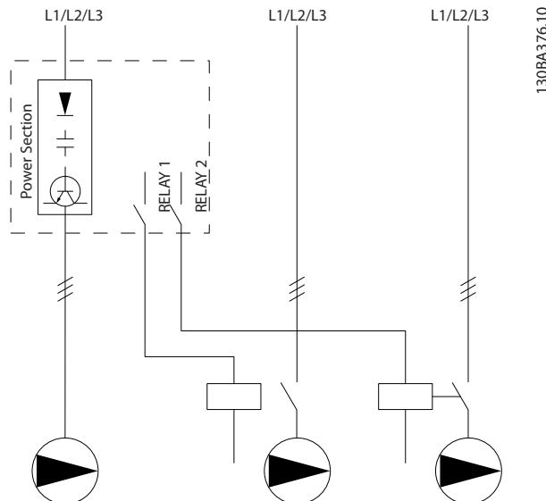
图 12.5 恒速泵/变速泵接线图
