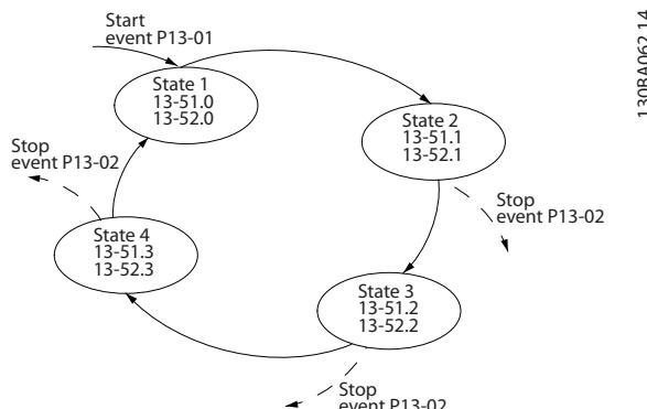
图 5.4 对 4 个事件/操作编程时的执行顺序
