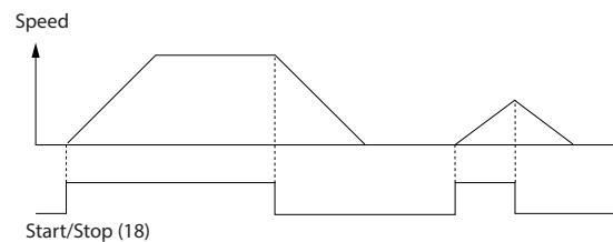
图 12.1 带 Safe Torque Off 的启动/停止
