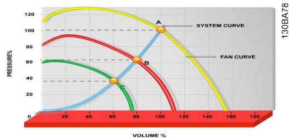
图 5.8 降低风扇容量时的风扇曲线
