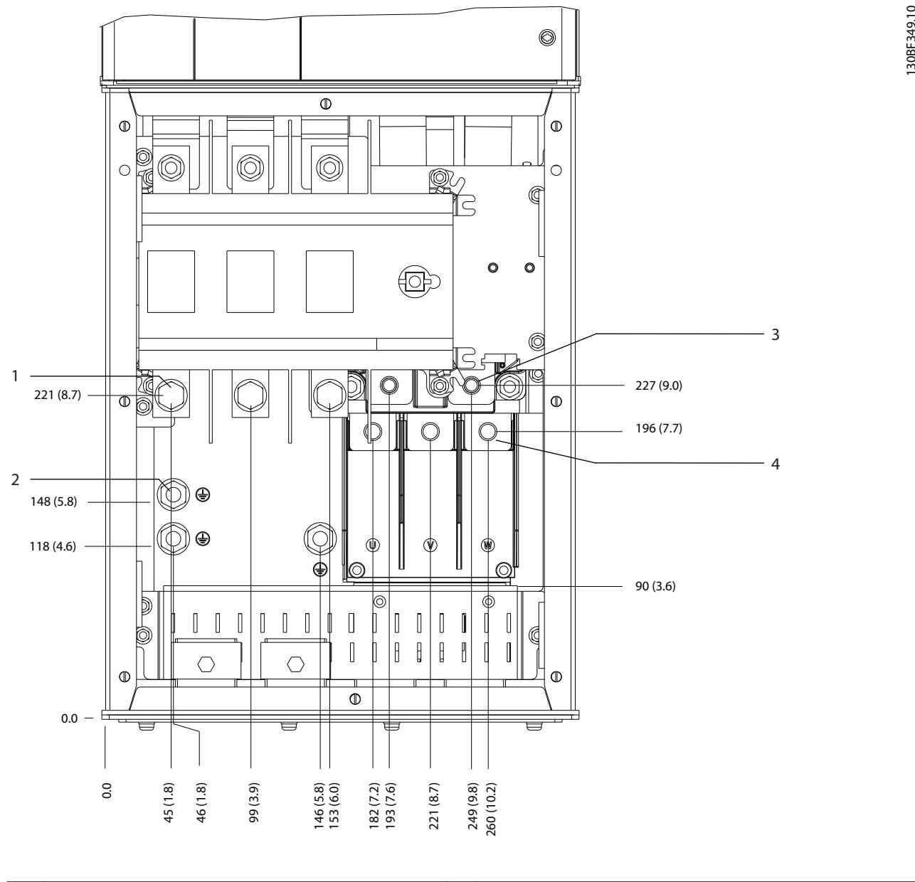
图 8.31 带隔离开关选件的 D5h 端子尺寸 (正视图)
