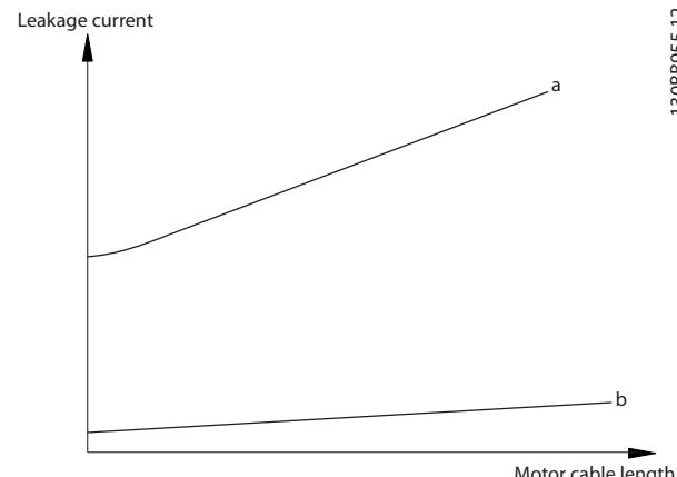
图 10.12 电机电缆长度和功率规格会影响漏电电流。
