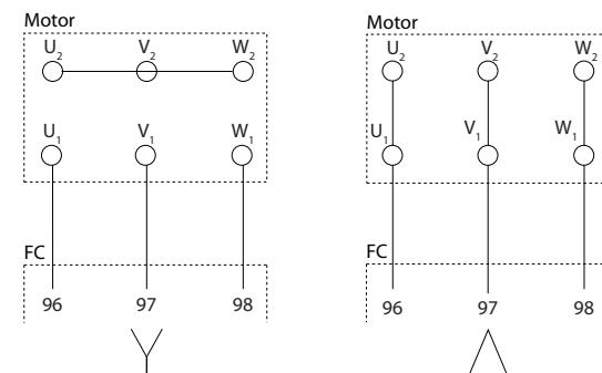
图 10.3 电动机电缆连接
