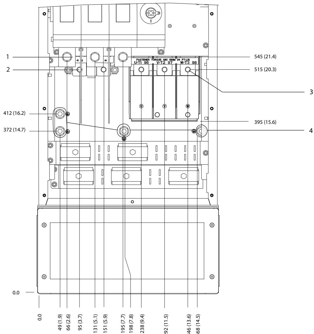
图 8.54 带隔离开关选件的 D7h 端子尺寸 (正视图)
