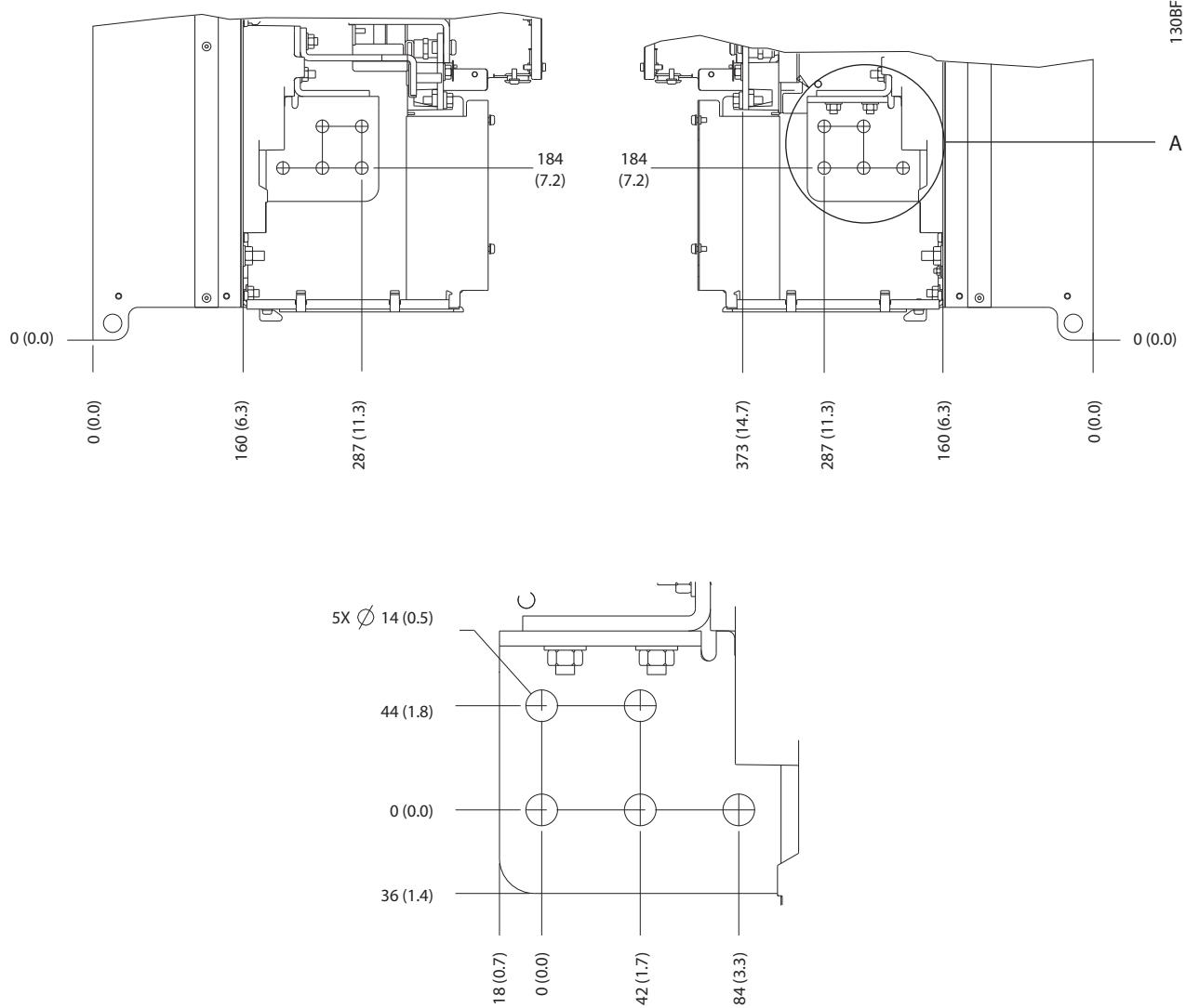
图 8.94 E4h 主电源、电机和接地端子尺寸（侧视图）
