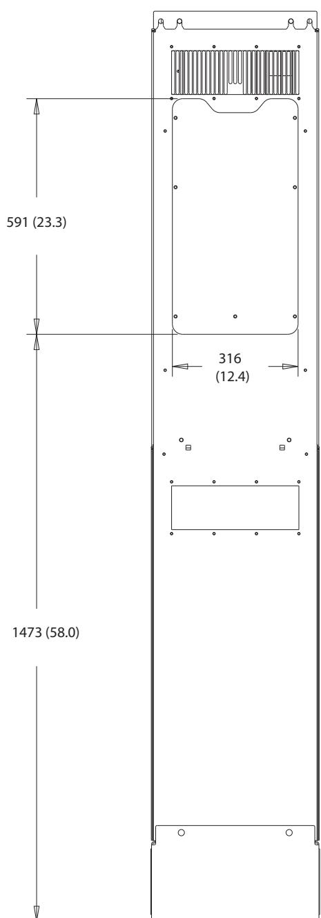
图 8.61 D8h 的散热片气流罩尺寸
