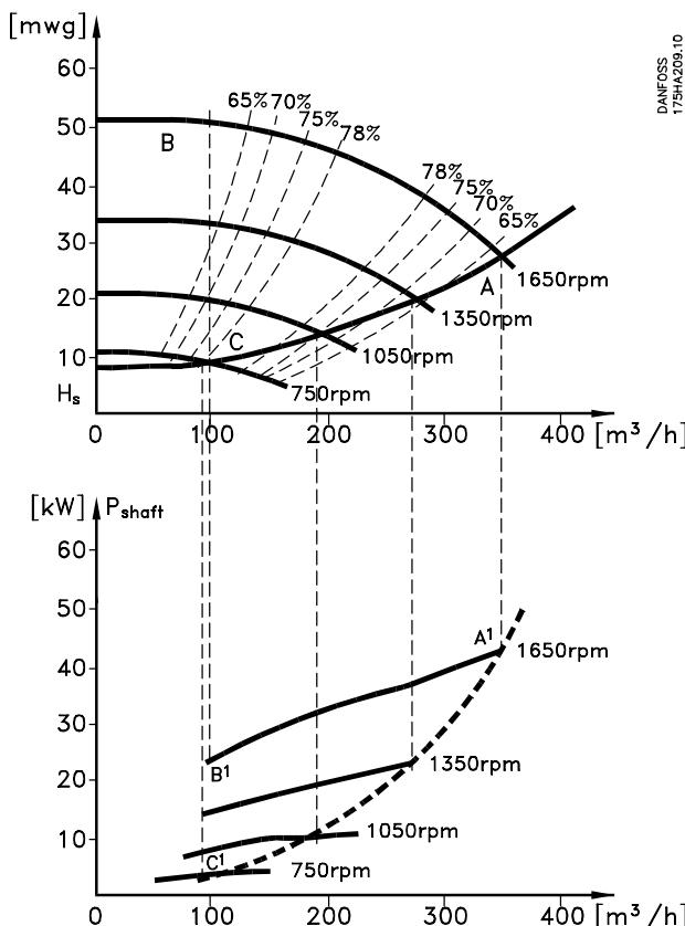
图 5.12 在潜水泵应用中实现节能
