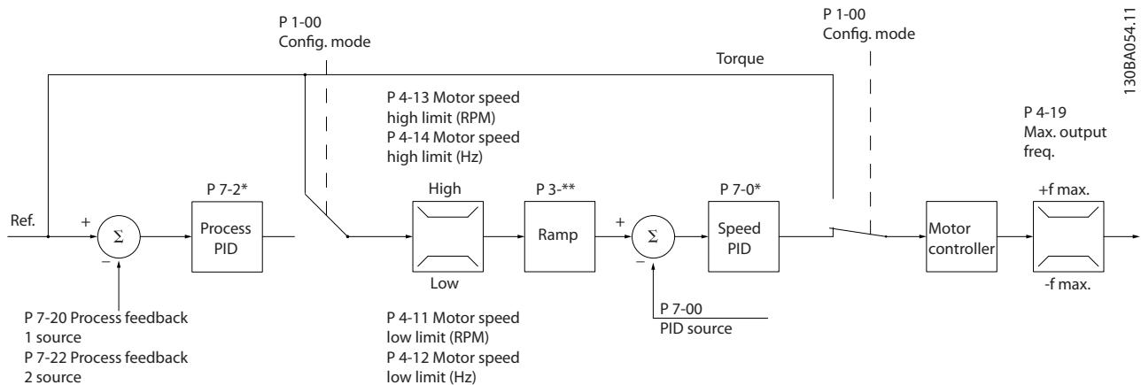
图 11.10 磁通矢量带反馈配置下的控制结构
