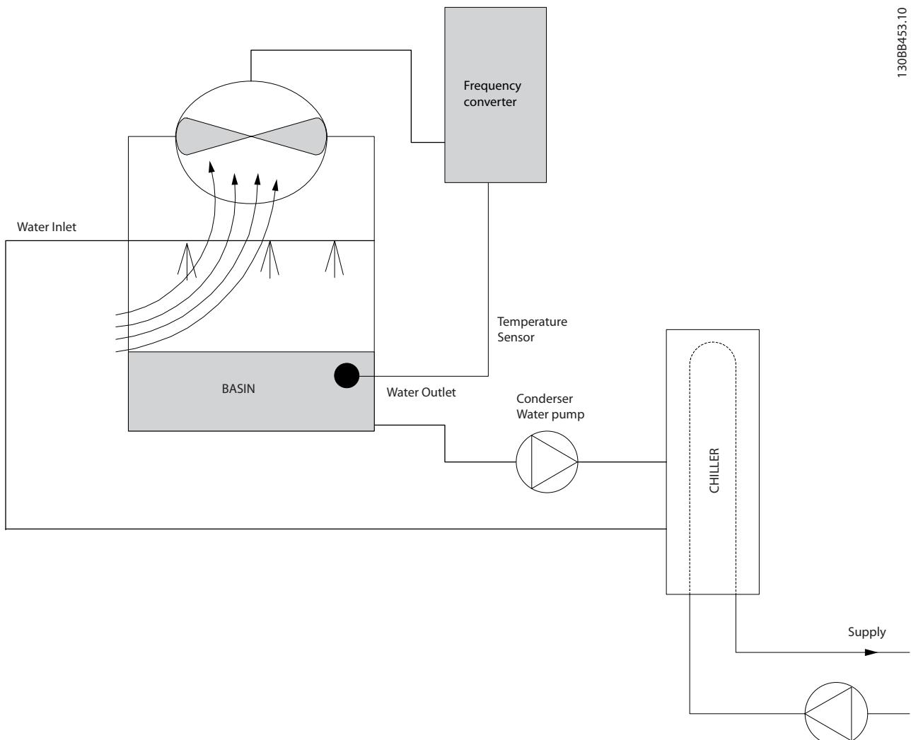
图 5.18 与冷却塔鼓风机一起使用的变频器
