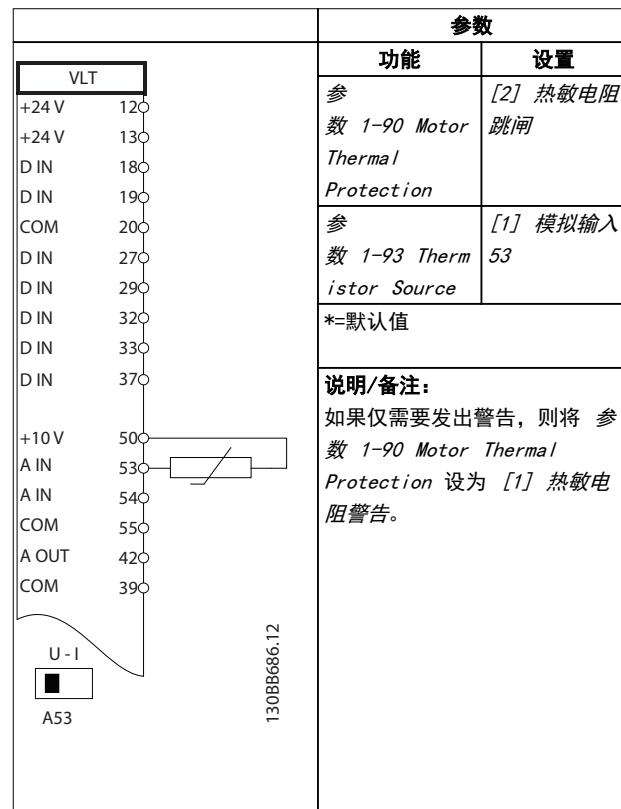
表 12.12 用于电机热敏电阻的接线配置
