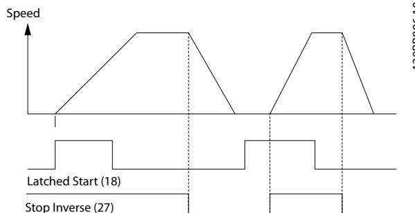
图 12.2 自锁启动/停止反逻辑
