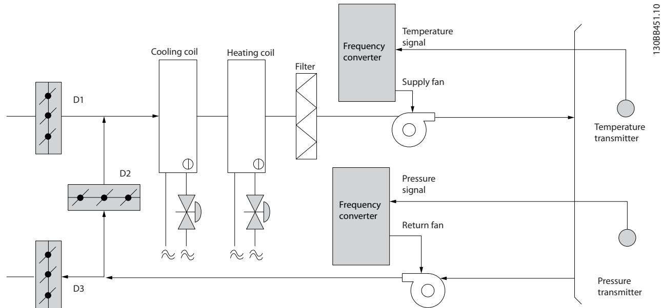
图 5.17 定风量系统中使用的变频器
