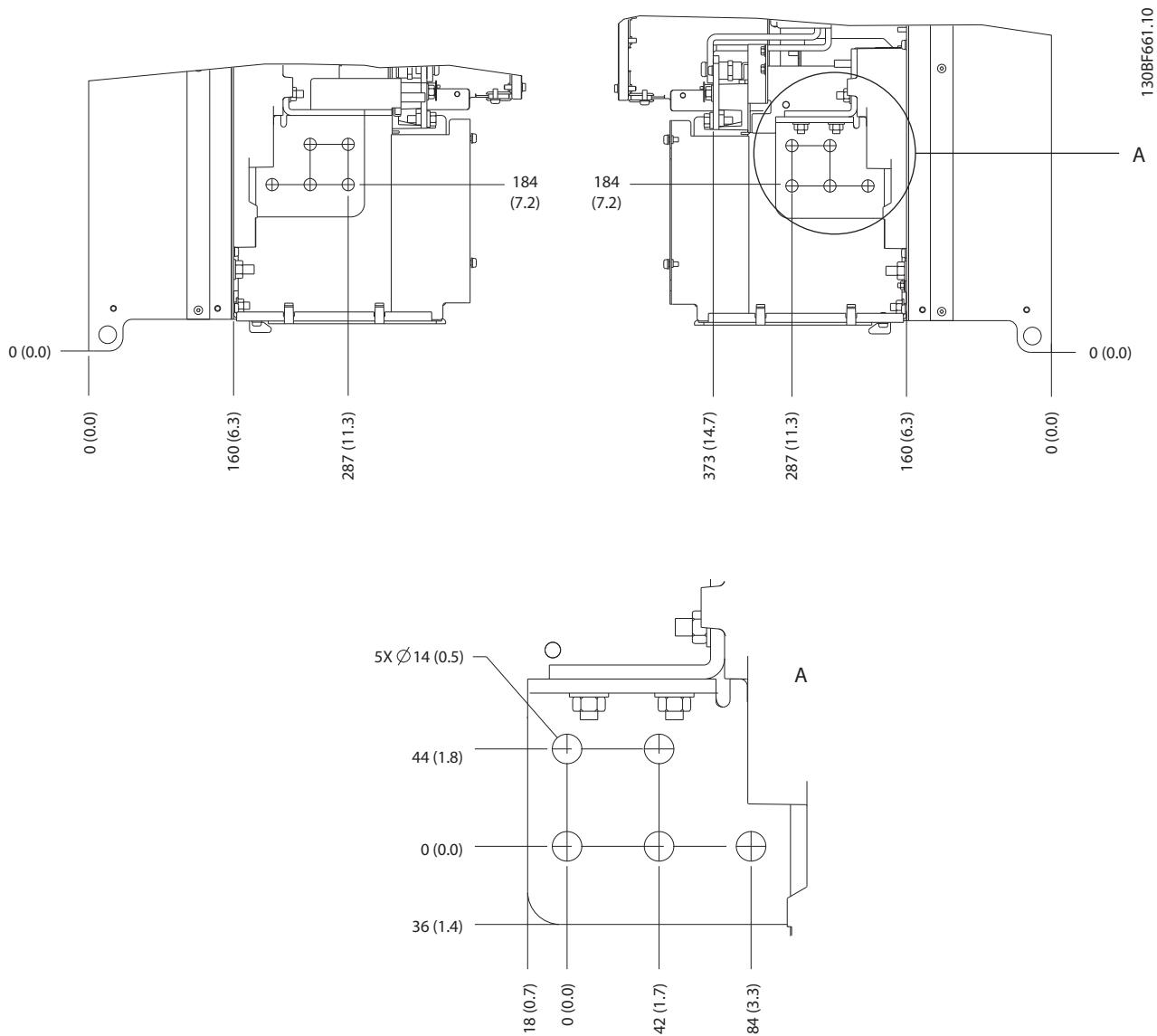
图 8.87 E3h 主电源、电机和接地端子尺寸（侧视图）
