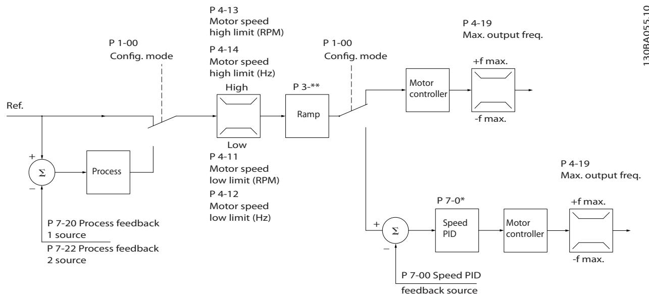
图 11.8 VVC<sup>+</sup> 开环和闭环配置下的控制结构
