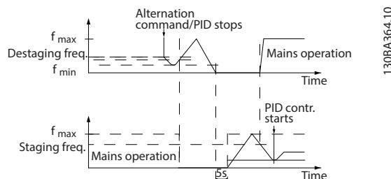
图 5.23 变频泵轮换
