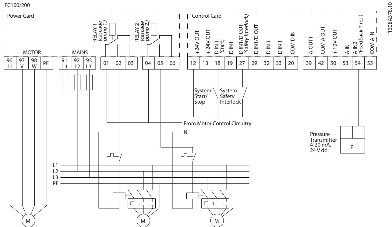
图 12.4 多泵控制器接线图
