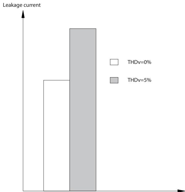
图 10.13 线路失真会影响漏电电流
