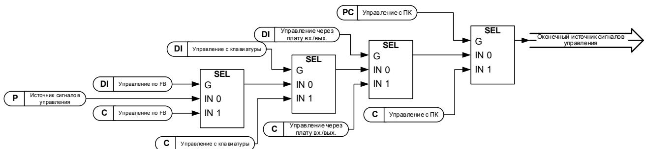
Рис. 7-9. Порядок приоритетов выбора источника сигналов управления
