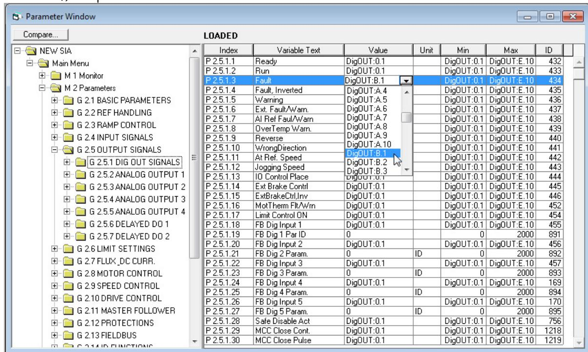
Рис. 4-1. Экран сервисной программы NCDrive; ввод кода адреса
