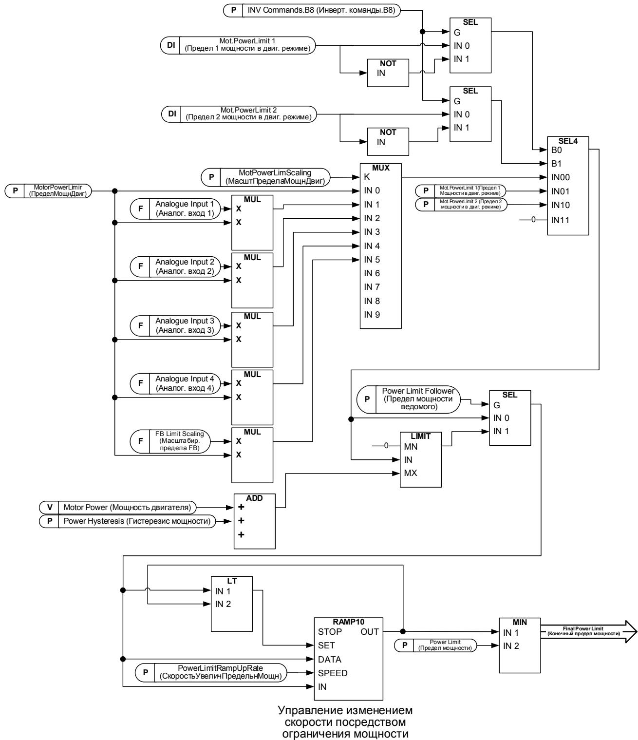
**P2.6.2.1 Предел мощности ID1722 «Power Limit» (Предел мощности)**
