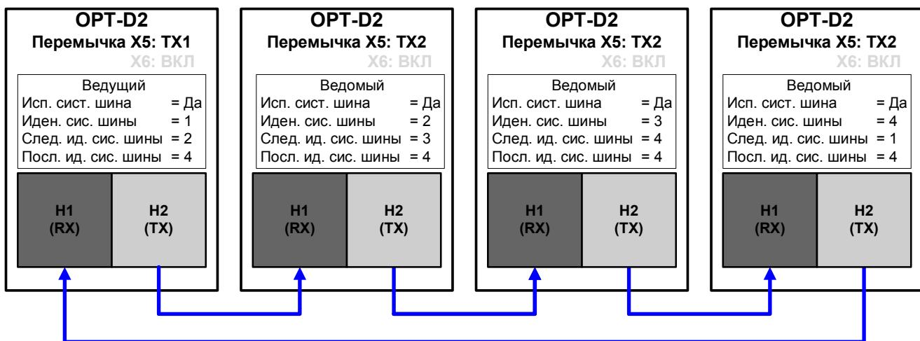
Рис. 7-16. Физическое подключение системной шины к плате OPT-D2
