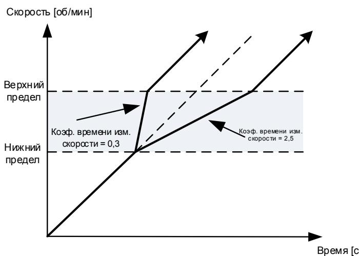
Рис. 7-1. Масштабирование изменения скорости между запрещенными частотами
