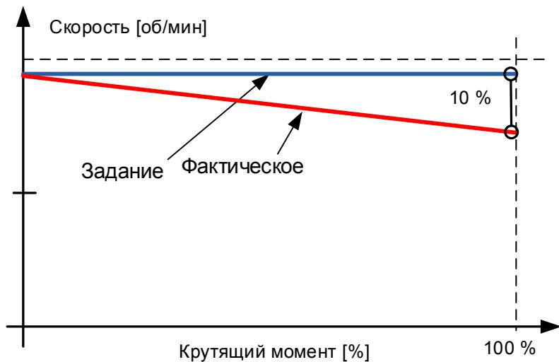
**Пример** Если снижение нагрузки задано равным 10 % для двигателя с номинальной частотой 50 Гц и двигатель нагружается номинальной нагрузкой (100 % от крутящего момента), то допускается уменьшение выходной частоты на 5 Гц от задания частоты. Этую функцию можно использовать, например, в том случае, если требуется балансировка нагрузки для механически взаимосвязанных двигателей.
