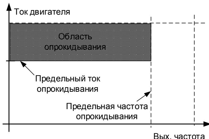
**P2.12.3.4 Время опрокидывания ID711 «Stall Time Lim» (Предел времени опрокидывания)**
