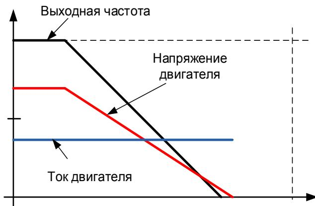
**1** = торможение магнитным потоком ВКЛ
