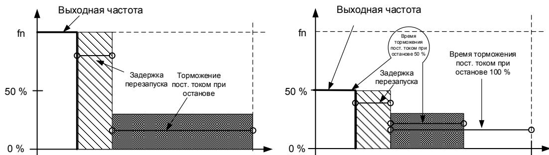
Рис. 7-14. Время торможения пост. током, если режим останова = Выбег, с номинальной скоростью и со скорости 50 % от номинальной.
