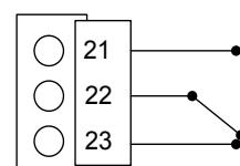
**Примечание.** При отсоединении питания от платы управления клеммы 22–23 размыкаются.
