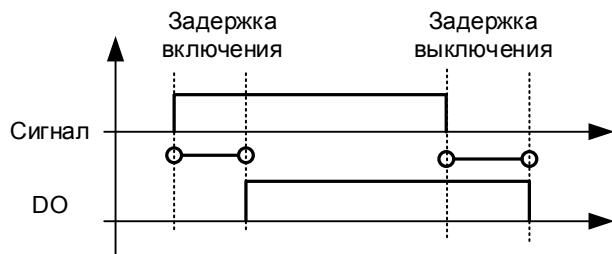
Рис. 7-11. Задержки включения и выключения цифровых выходов 1 и 2
