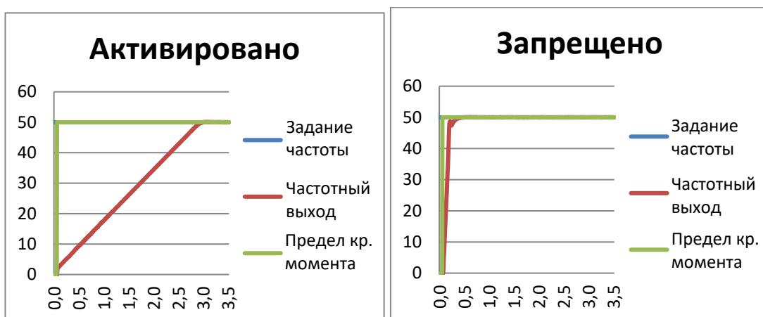
**P2.3.12.3 Постоянная времени интерполятора задания скорости ID1184 «Ramp In Inter. TC» (Постоянная времени входа интерполятора скорости)**
