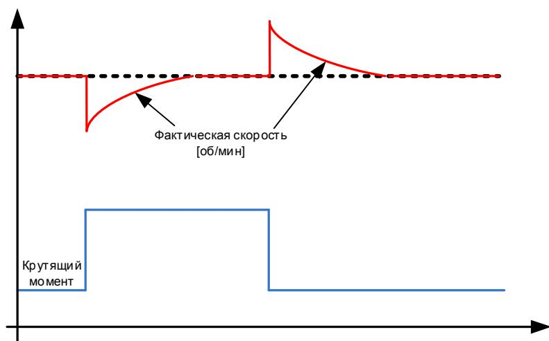
**P2.9.3 Устранение падения нагрузки ID1534 «LoadDroopRemoval»
