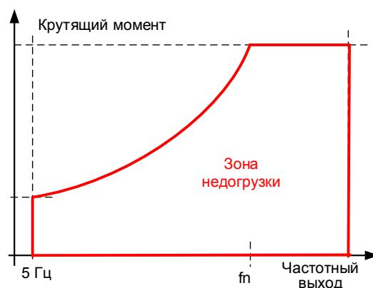
**P2.12.7.4 Время недогрузки ID716 «UP Time Limit» (Предельное время защиты от недогрузки)**
