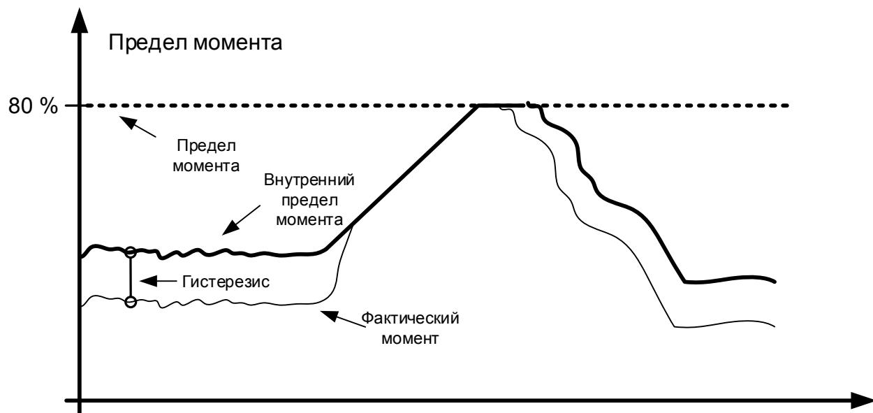
**P2.6.3.9 Масштабирование предельного крутящего момента двигателя ID485 «MotTorqLimSclng» (Масштабирование предельного момента двигателя)**
