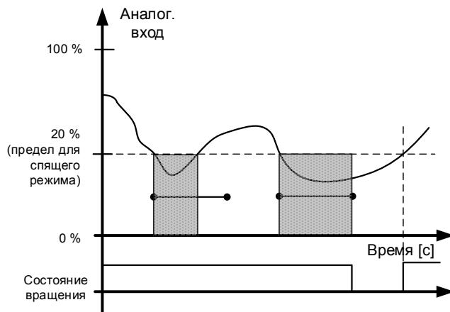
**P2.4.3.9 Предел для спящего режима AI1 ID385 «AI1 Sleep Limit» (Предел для спящего режима AI1)**
