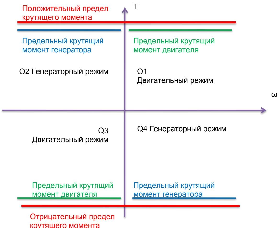
**P2.6.3.1 *Torque Limit (Предел момента)* ID609 «Torque Limit» (Предел момента)**
