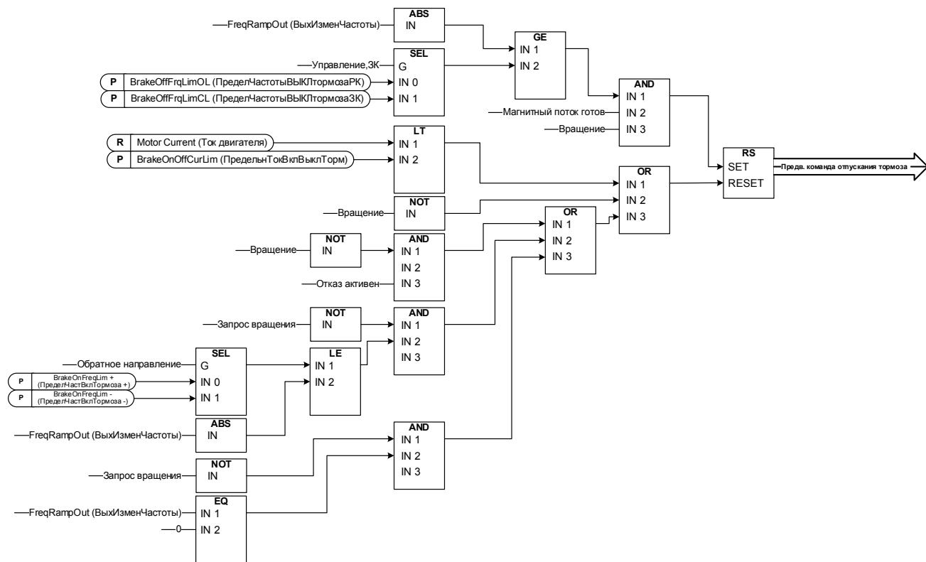
**Конечная команда отпускания тормоза:** В системе «Ведущий/ведомый» ведущий преобразователь частоты может отпускать тормоз. Кроме того, это может сделать дублирующая система управления без каких-либо операций управления со стороны преобразователя частоты, используя слово AuxControlWord1.B7. Во время выполнения идентификации тормоз не может быть отпущен.
