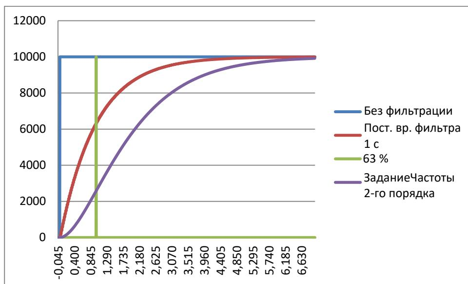
Рис. 7-10. Фильтрация сигнала AI1
