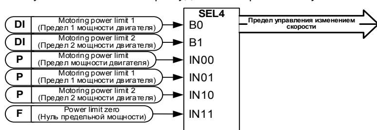
**P2.6.2.8 Скорость увеличения предельной мощности ID1502 «PowerLimitInc.rate» (СкорУвПредельнМощн.)**
