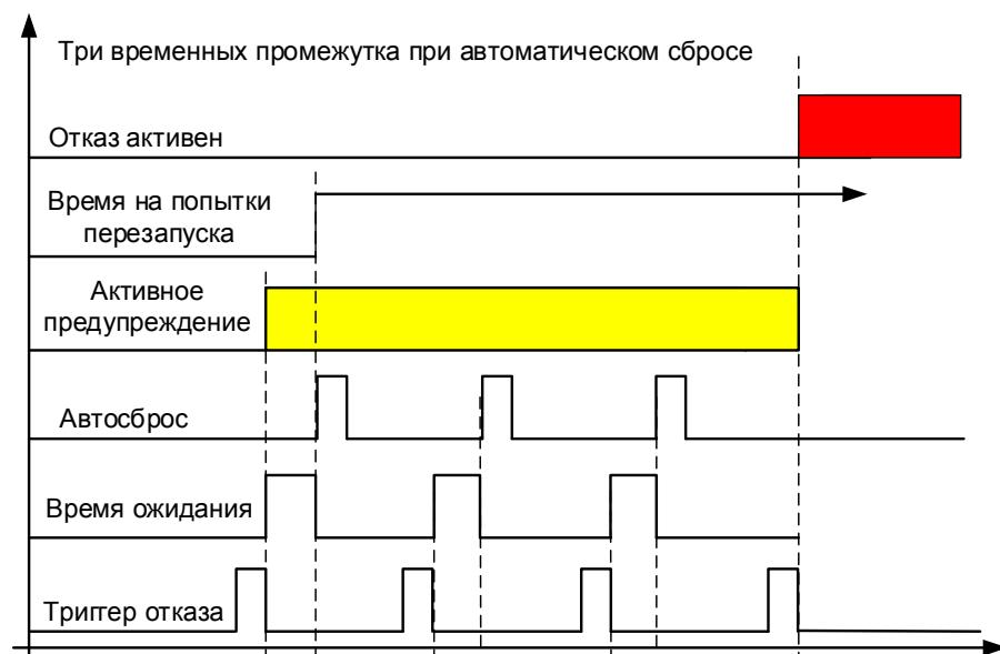
Рис. 7-18. Пример автоматического перезапуска с использованием трех попыток
