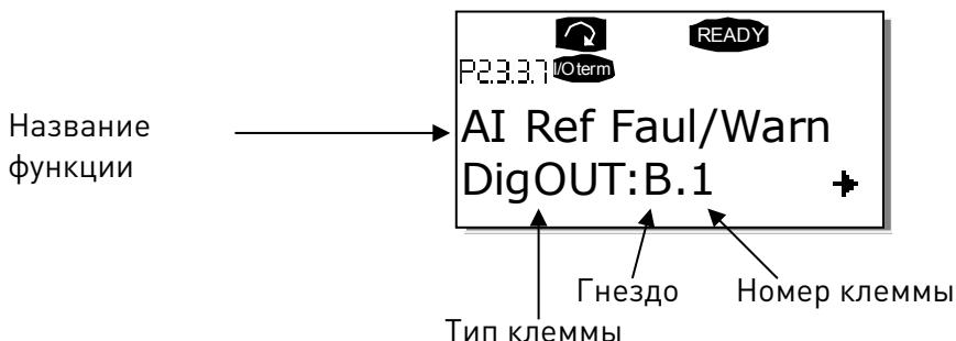
**Пример.** Нужно подключить функцию цифрового выхода «Отказ/предупреждение задания» (параметр 2.3.3.7) к цифровому выходу D01 на базовой плате NXOPTA1 (см. Руководство пользователя VACON® NX).
