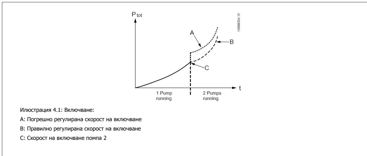
Когато системата заработи, тя ще следи действителното потребление на енергия и ще извършва фина настройка при всяко включване или изключване.
