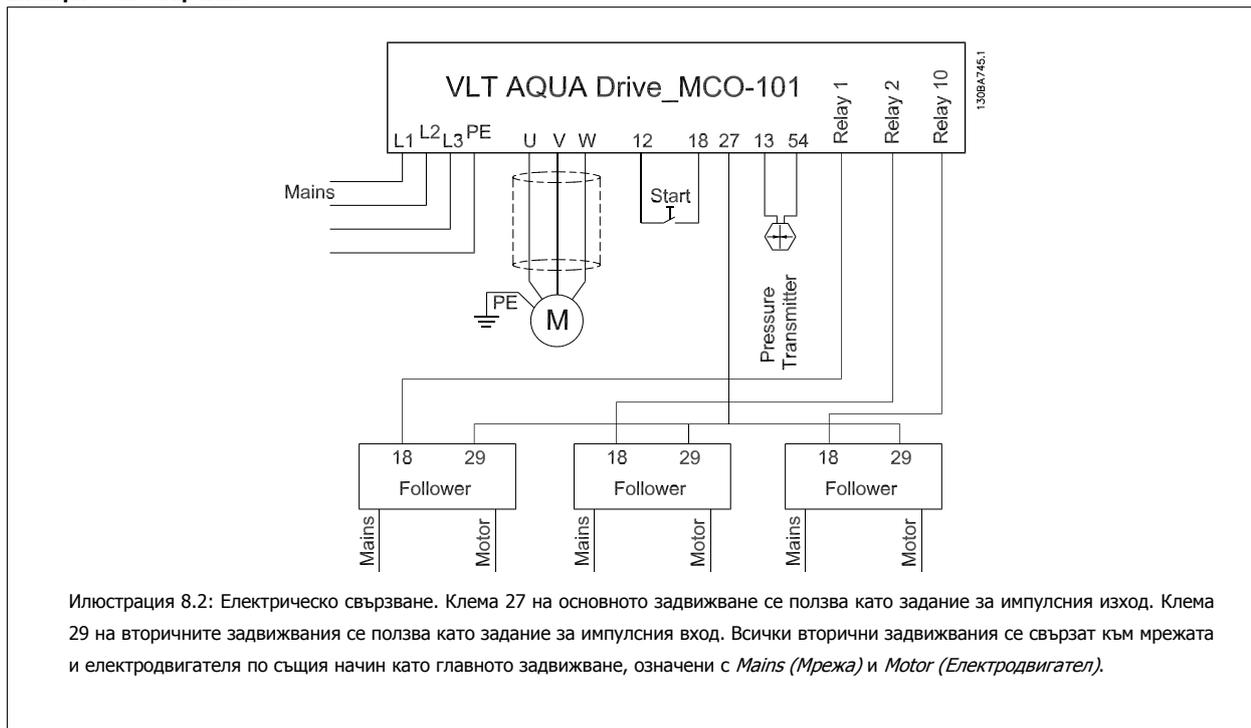
Илюстрация 8.2: Електрическо свързване. Клема 27 на основното задвижване се ползва като задание за импулсия изход. Клема 29 на вторичните задвижвания се ползва като задание за импулсия вход. Всички вторични задвижвания се свързат към мрежата и електродвигателя по същия начин като главното задвижване, означени с *Mains* (Мрежа) и *Motor* (Електродвигател).
